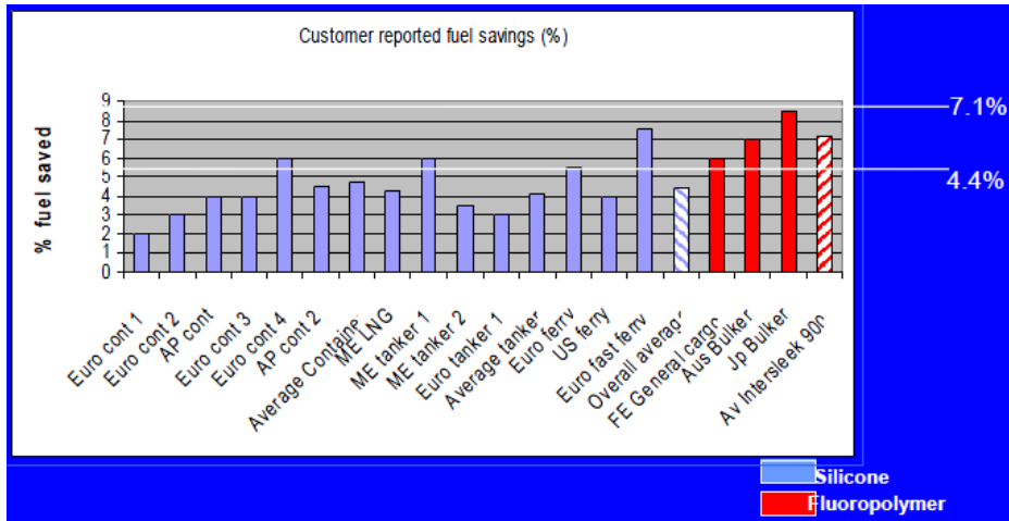
Σχήμα 41. Μείωση της κατανάλωσης καυσίμου με χρήση επιστρώσεων αποδέσμευσης ρύπων (Willsher J-International Paint Ltd.)
