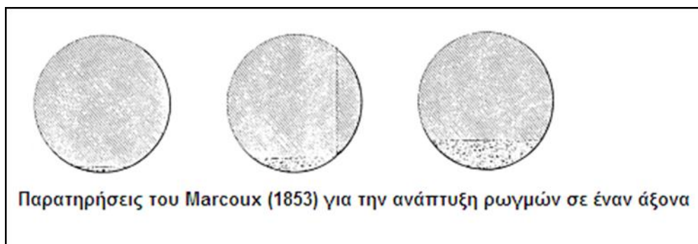
Εικόνα 1.8: Ανάπτυξη των ρωγμών στον άξονα από τον Marcoux (1853). (Sendekiγj, 2006)
