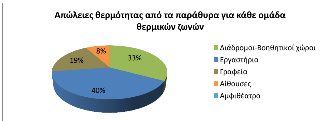
Εικ. 14.20: Ετήσιες απώλειες θερμότητας από τα παράθυρα για κάθε ομάδα θερμικών ζωνών
