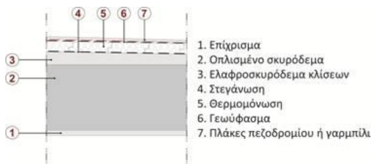
Εικ. 16.34: Τομή μόνωσης του δώματος
