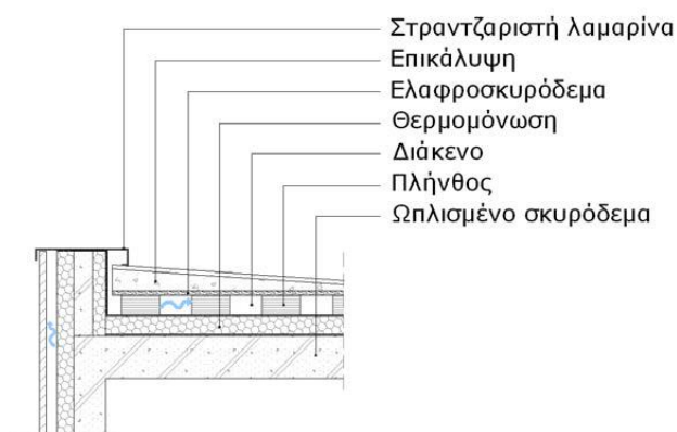
Εικ. 5.15: Τομή σε αεριζόμενο δώμα [1]
