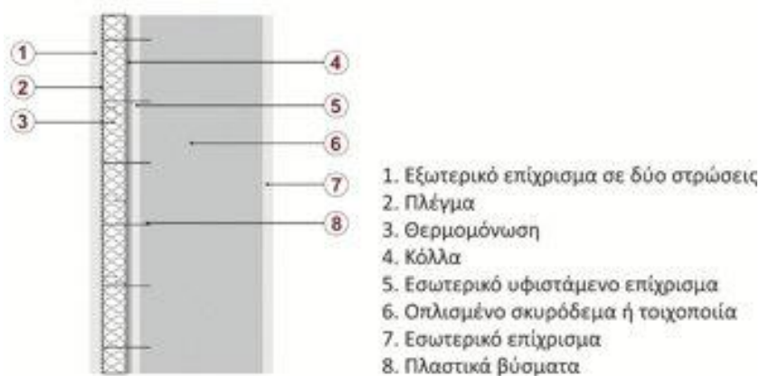
Εικ. 7.3: Στρώσεις εξωτερικής θερμομόνωσης [84]
