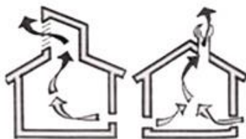
Εικ. 5.14: Καμινάδα ή πύργος αερισμού [64]
