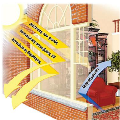
Εικ. 16.6: Τζάμια χαμηλής εκπομπής Low-emissivity (Low-e)
