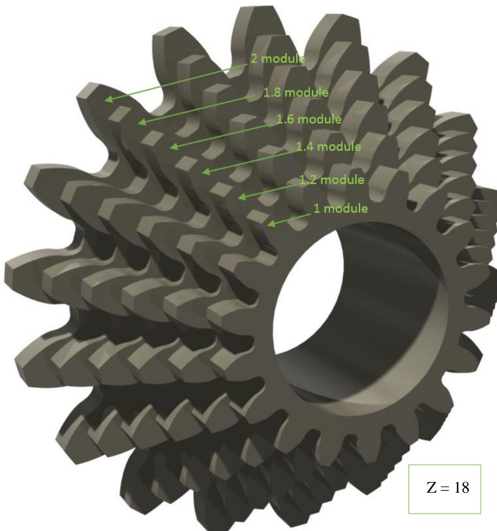
Εικόνα 7 - Οδοντώσεις με ίδιο αριθμό οδόντων και διαφορετικό module
