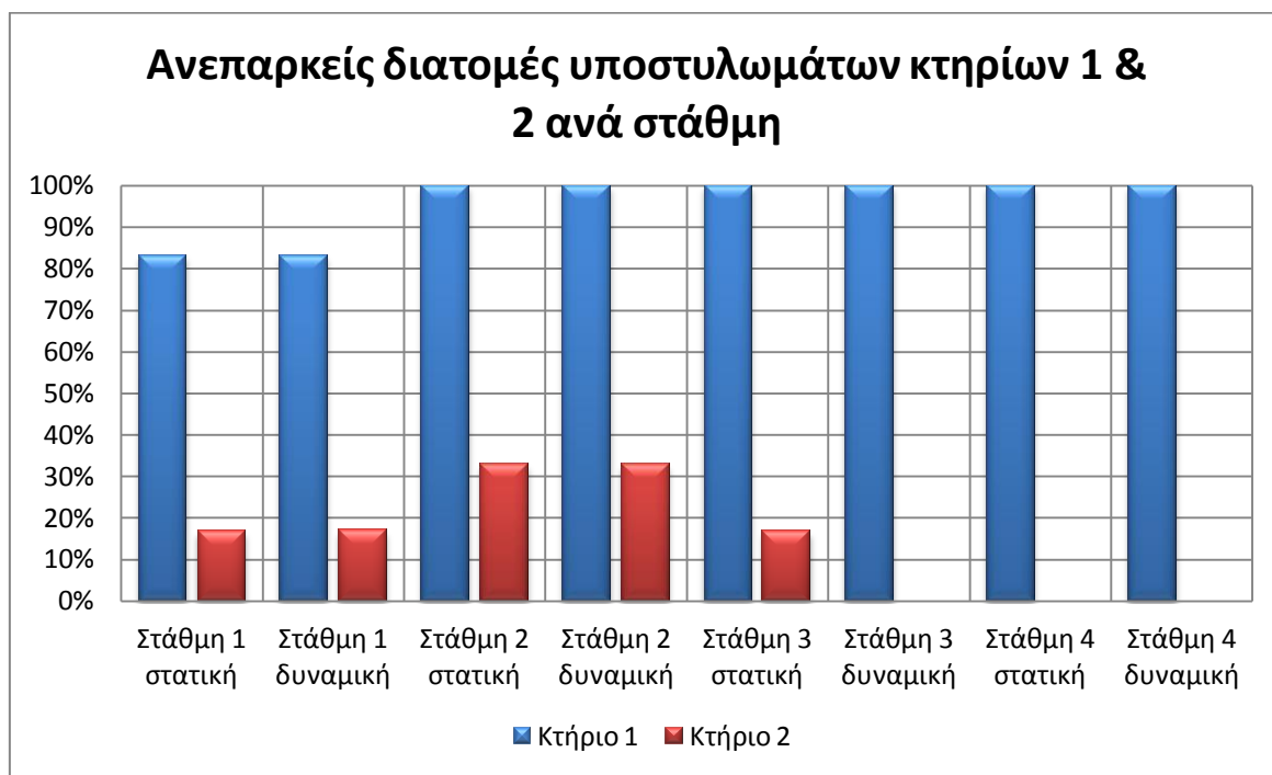
Σχήμα 3.23 Ανεπαρκείς διατομές υποστυλωμάτων κτηρίων 1 και 2 ανά στάθμη στατικής και δυναμικής ανάλυσης.
