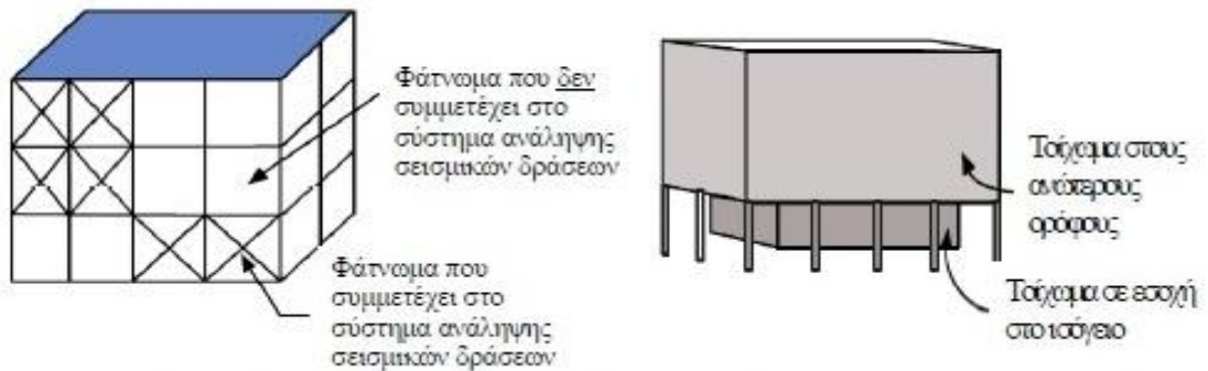
Σχήμα 2.4 Παραδείγματα μη κανονικότητας καθύψος: Διακοπή φορέα καθύψος (αριστερά), εκτός επιπέδου εσοχή (δεξιά).
