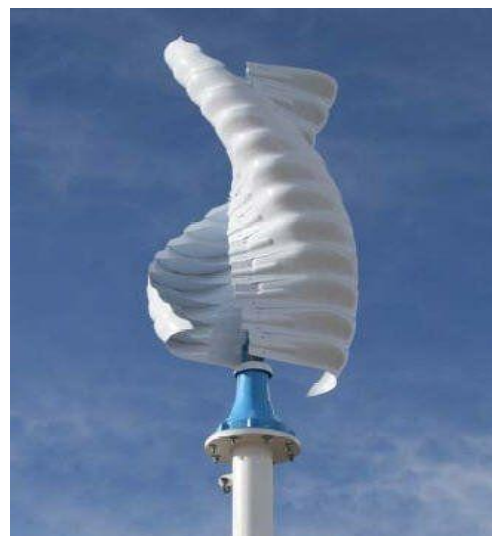
Εικόνα 3.10. Ανεμογεννήτριες κατακόρυφου άξονα, τύπου Darrieus (αριστερά) και τύπου Savonius (δεξιά). [Πηγές: http://de.wikipedia.org/wiki/Darrieus-Rotor , http://www.helixwind.com ]
