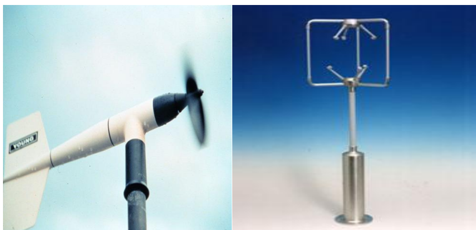
Εικόνα 2.14. Ανεμόμετρο τύπου ανεμόμυλου (αριστερά) και ανεμόμετρο τεχνολογίας υπερήχων για μέτρηση στο τρισδιάστατο πεδίο ροής ταχυτήτων (δεξιά).
