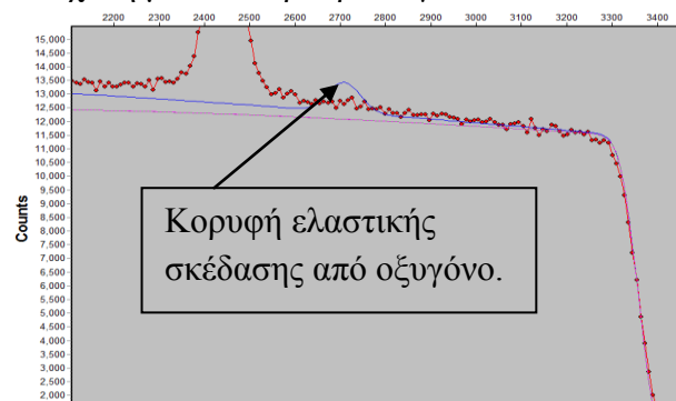
Σχήμα 3.5.4β: Φάσμα σκέδασης πρωτονίων με ενέργεια 3500keV. Για το προσομοιωμένο φάσμα (μπλε) χρησιμοποιήθηκε στόχος με 10% οξυγόνο στο στρώμα βορίου. Είναι εμφανές ότι η ποσότητα αυτή θα έδινε κορυφή ευδιάκριτη σε σχέση με το υπόβαθρο λόγω ταντάλου.
