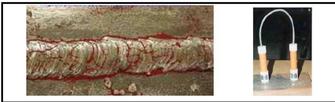
Εικόνα 6: Χαρακτηριστική ανάδειξη ελαττωμάτων μέσω της χρήσης μαγνητικών σωματιδίων τα οποία αφού έχουν μαγνητιστεί μαζί με το υλικό δημιουργούν διάφορα σχήματα στην επιφάνεια της συγκόλλησης.
