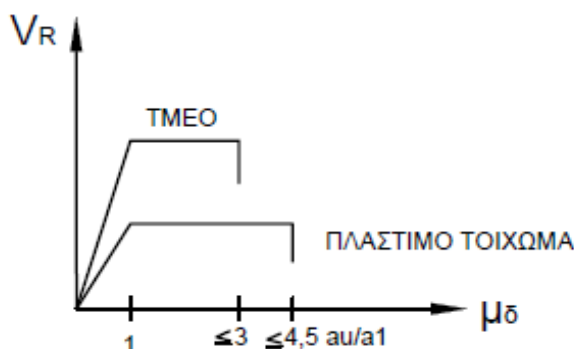
Διάγραμμα 1 : Διαφορά μεταξύ ενός μεγάλου ελαφρά οπλισμένου τοιχώματος σε μέση κατηγορία πλαστιμότητας και ενός πλάστιμου τοιχώματος σε υψηλή κατηγορία πλαστιμότητας, όπου \alpha_u/\alpha_1=1,0\div1,2(1,5)
