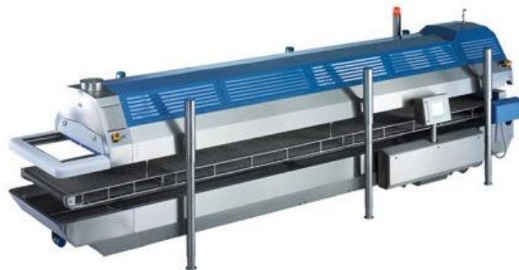
Εικόνα 4.25 Καταψύκτης κρυογονικής κατάψυξης μούρων (Πηγή: http://www.globalspec.com )
