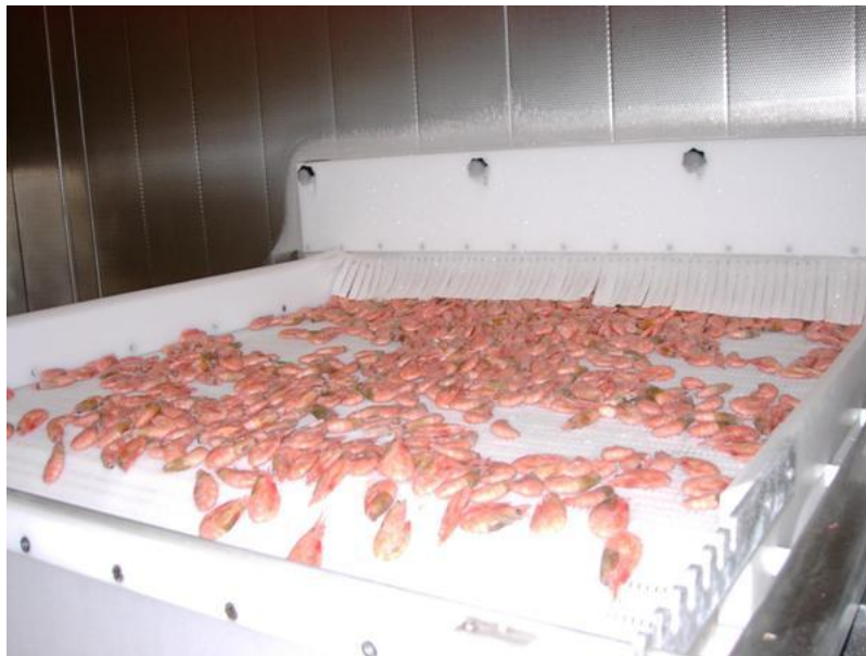
Εικόνα 5.10 Κατάψυξη γαρίδων σε καταψύκτη κρυογονικής κατάψυξης, φάση εξόδου από σήραγγα (Πηγή: http://www.pbaindustrial.com )
