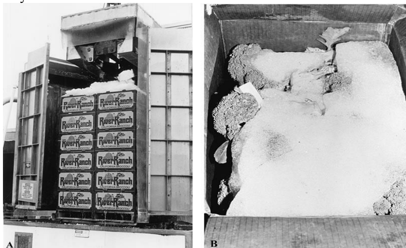
Εικόνα 5.4 Πρόψυξη μπρόκολου με πάγο (Πηγή: http://riverranch.com )
