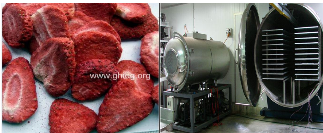
Εικόνα 5.5 Ξήρανση και ψύξη φράουλας με κρυογονική μέθοδο (Πηγή: http://www.ghieg.org )
