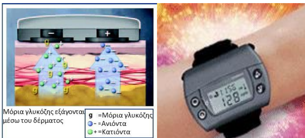
Εικόνα 2.3: Σχηματική παράσταση αρχής λειτουργίας διάταξης μέτρησης γλυκόζης με αντίστροφο ιονισμό [13].
