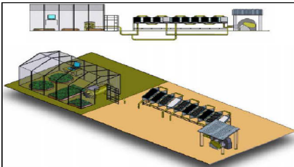
Σχήμα 3.8: Απεικονίσεις του πειραματικού εξοπλισμού ηλιακού θερμοκηπίου με PCM.
