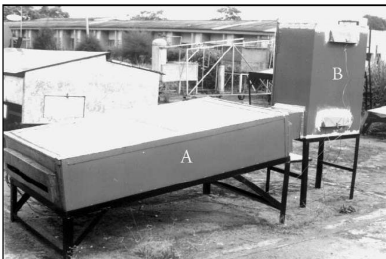
Σχήμα 3.5: Φωτογραφία ενός ηλιακού θερμοσίφωνα αέρα, όπου Α:συνδεσμολογία του συλλέκτη με την ενεργειακή αποθήκευση και τα υποσυστήματα θέρμανσης αέρα και Β:θερμαινόμενος χώρος.
