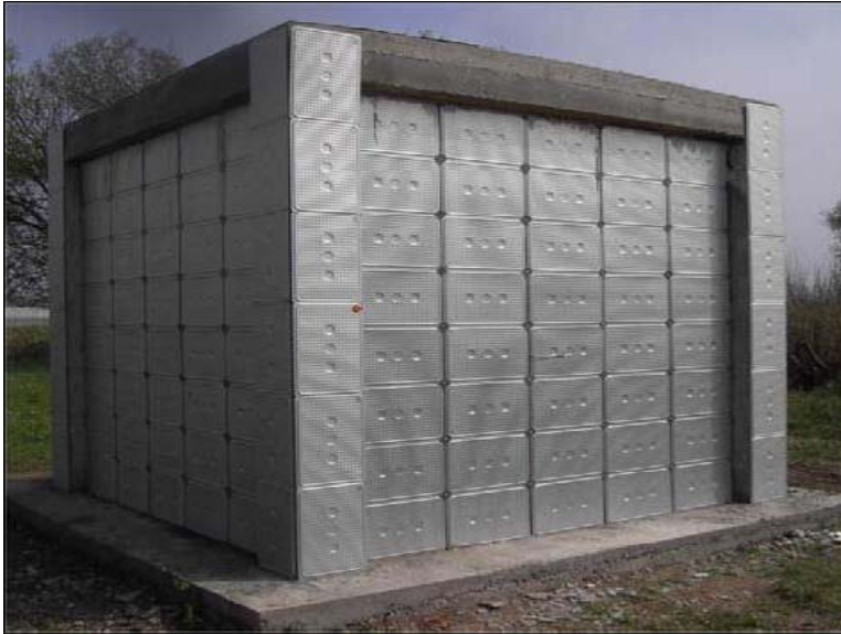
Σχήμα 4.14: Θάλαμος από τούβλο με RT27 και πολυουρεθάνη
