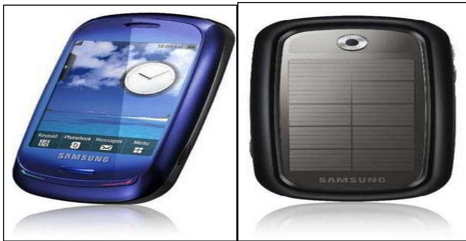
Σχήμα 3.24: Στο πρώτο τηλέφωνο από την Samsung με ηλιακές μπαταρίες και θήκη που περιέχει PCM.
