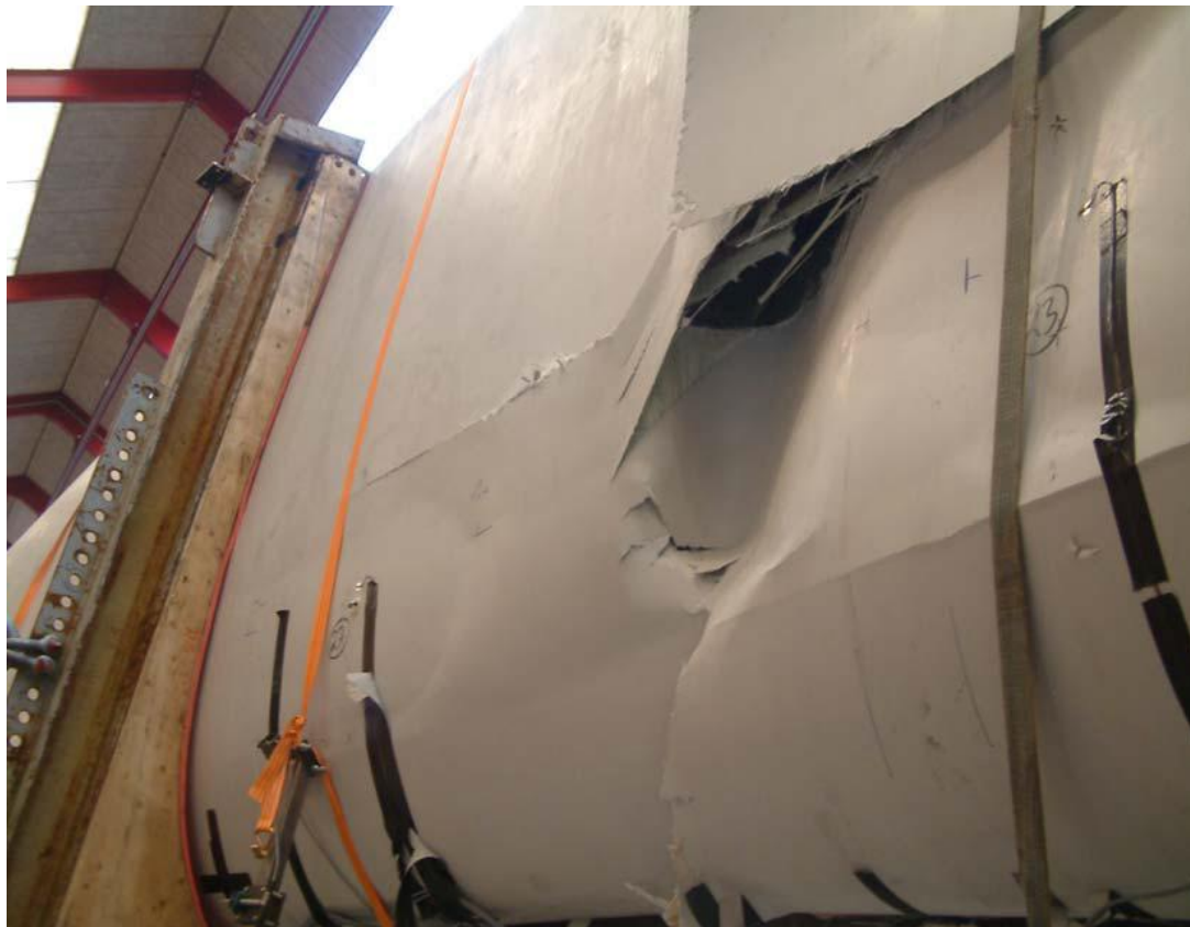
Εικόνα 4.2 Αστοχία πτερυγίου σε λυγισμό μετά από πείραμα (full-scale test)
