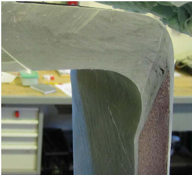
Εικόνα 4.11 Πειραματικό μοντέλο με ply-drop στη μεταβατική περιοχή
