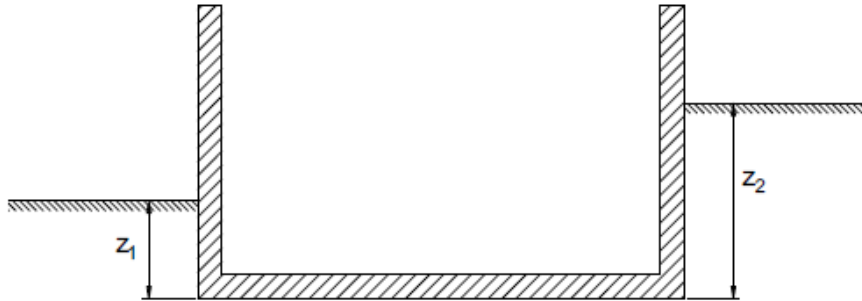
Σχήμα 5.1. Ενδεικτική διατομή κτιρίου για τον προσδιορισμό του το βάθους έδρασης πλάκας επί εδάφους με διαφορετικές στάθμες έδρασης λόγω κεκλιμένου εδάφους.
