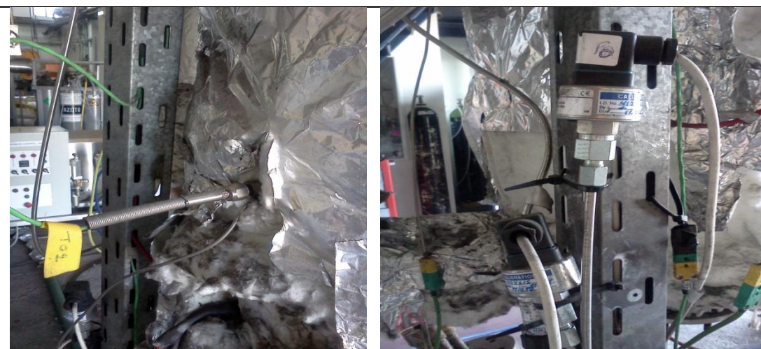
α. Θερμοστοιχείο τύπου K
