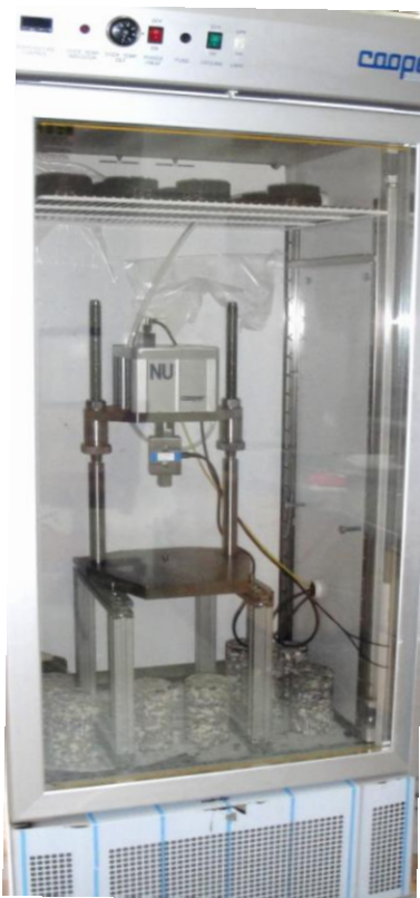
Σχήμα 4.6. Θάλαμος τοποθέτησης για απαιτούμενη θερμοκρασία δοκιμής
