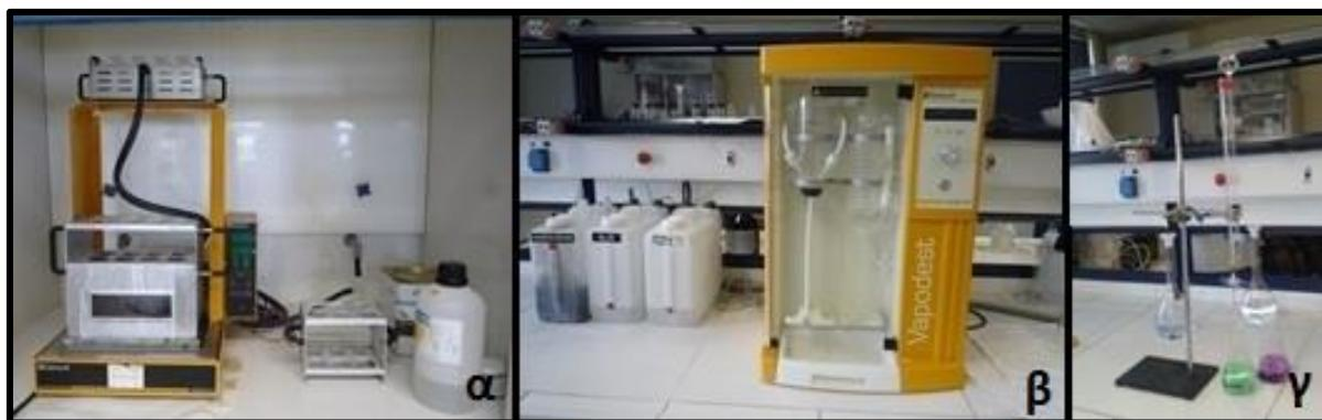
Εικόνα 6: Συσκευή χώνευσης Gerhard Kjeldatherm (α), συσκευή απόσταξης Gerhard Varodest (β), τιτλοδότηση (γ)
