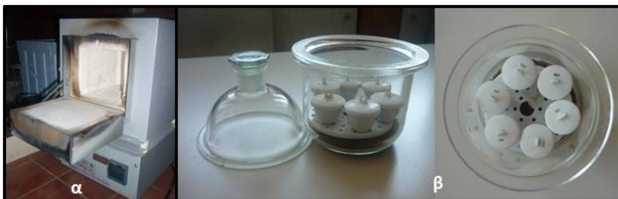
Εικόνα 8: Κλίβανος (α) και ξηραντήρας με τις κάψες (β) για τον υπολογισμό της παραμέτρου LOI
