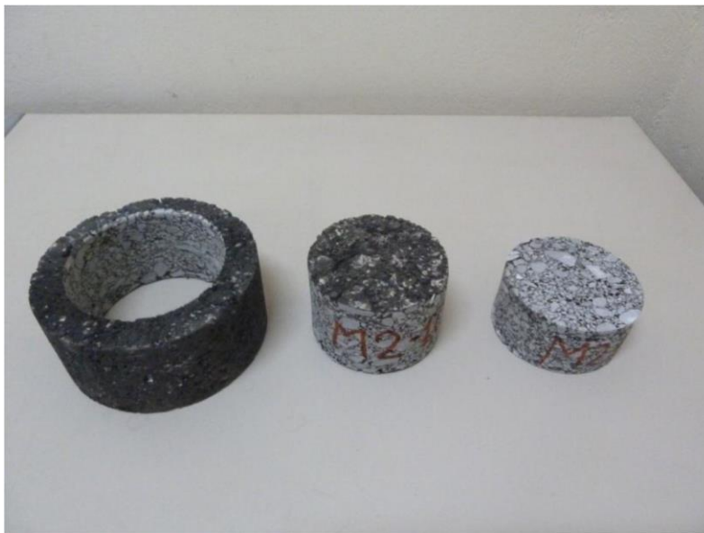
Σχήμα 3.5 Δοκίμιο διαμέτρου 150mm και ύψους 70mm και διαδοχική πυρηνοληψία και κοπή
