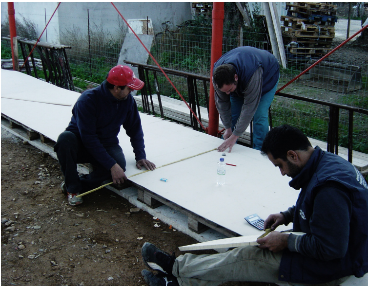
81. Μεταφορά των διαστάσεων του μισομόделου, στη σάλα σε κλίμακα 1:1
