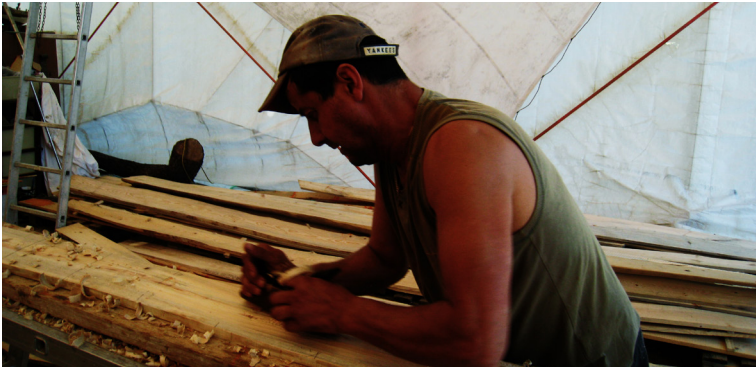
30. Λάξευση του εσωτερικού των μαδεριών του πετοώματος με ειδικό ροκάνι, αλλιώς 'γούβωμα'. Γι' αυτήν την εργασία το παραδοσιακό εργαλείο κρίνεται καταλλπότερο από αντίστοιχο σύγχρονο ηλεκτρικό σβουράκι
