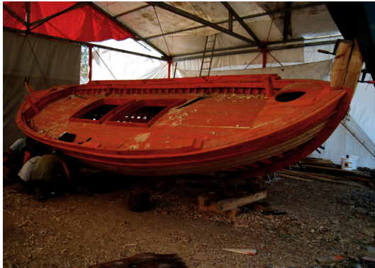
178. Το σκάφος μπατάρει για να διευκολύνονται οι εργασίες
