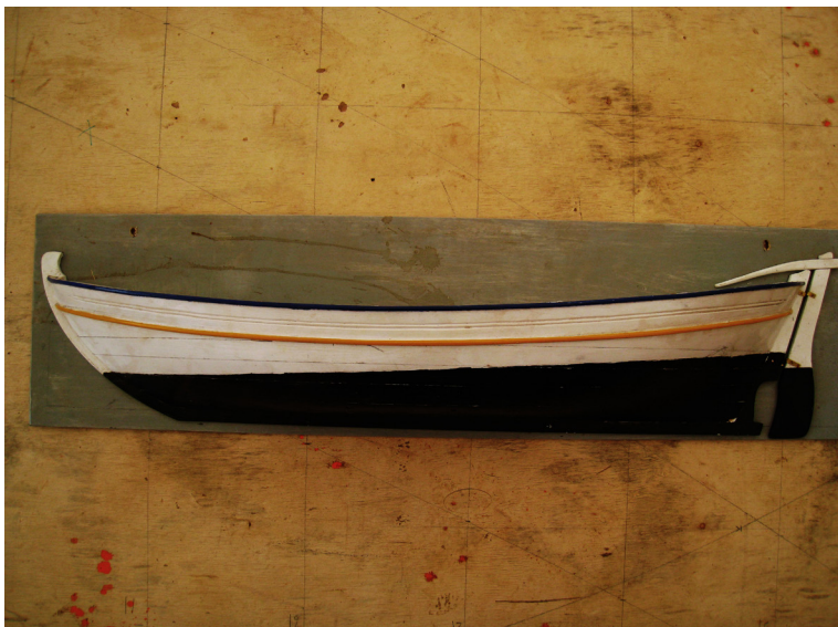
71. Το μισομόδελο του τρεχαντηριού που ναυπηγείται στο καρνάγιο του Κωστή
