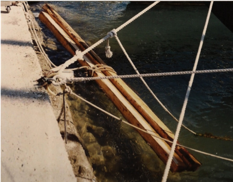
84. Εμβραπισμός των ξύλων στη θάλασσα, για μεγαλύτερη αντοχή στη διάβρωση
