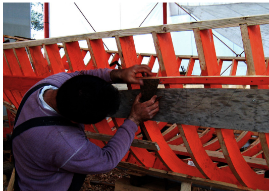
128. Αποτύπωση του σχήματος της τσάπας στη σταιζόλα με το μασταρί
