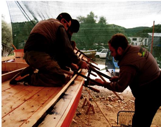
162. Στερέωση του μπακαλαριού με σφιγκτήρες
