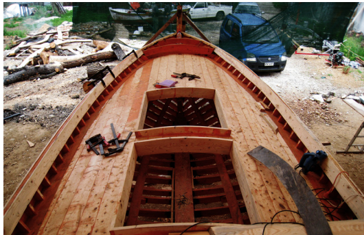
163. Αποψη της κουβέρτας με τα μπακαλάρια τοποθετημένα
