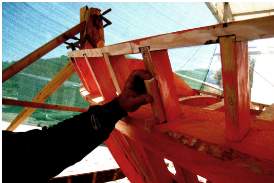
157. Μέτρηση της γωνίας που σχηματίζει ο κάθε νομέας με το τρυπητό με αυτοσχέδια στέλα
