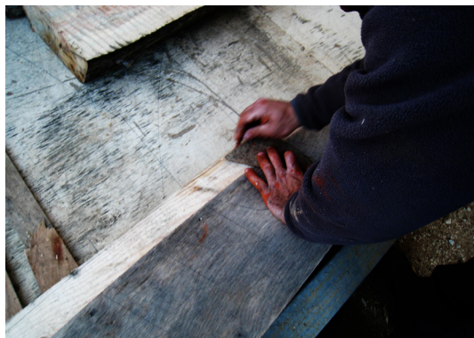
129. Εύρεση και σημάδεμα του κατάλληλου μαδεριού
