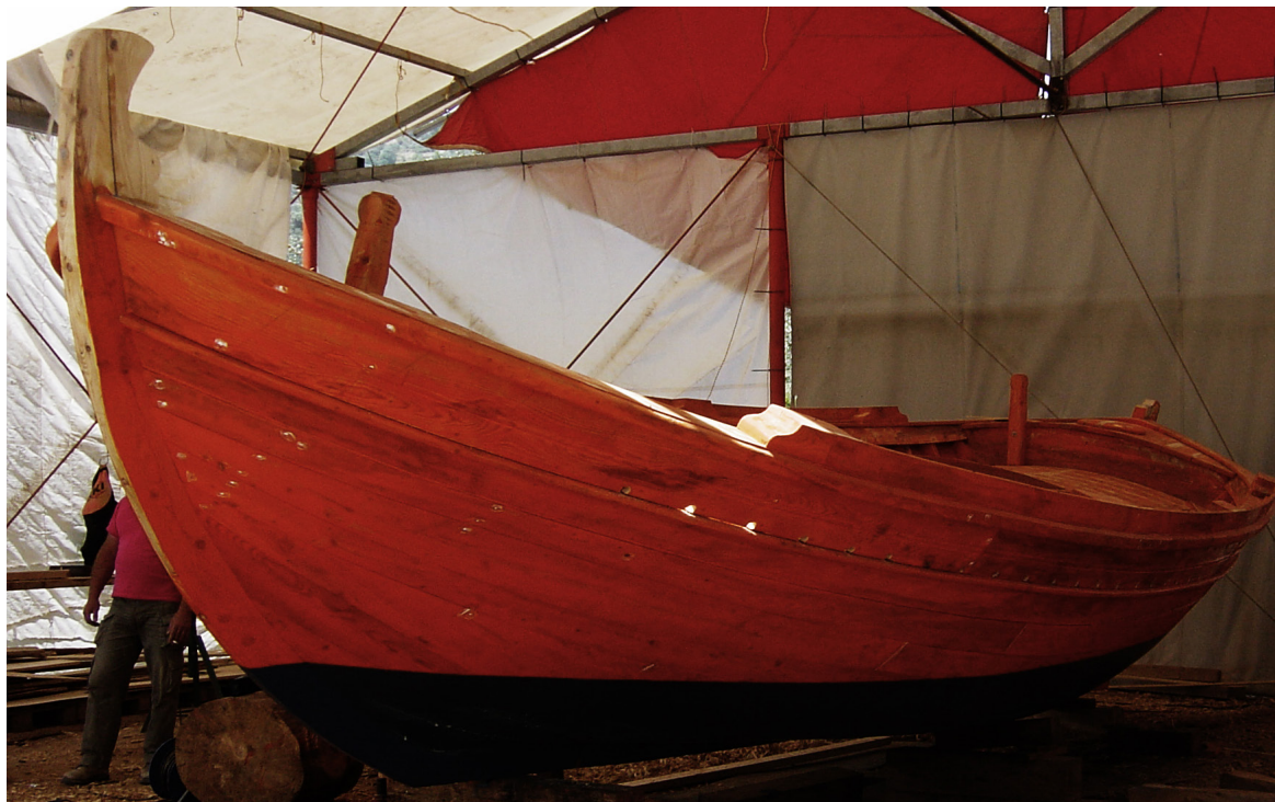
188. Το καϊκι στην τελευταία φάση της κατασκευής του, μετά την ολοκλήρωση του πετσώματος, στοκάρεται και καλαφιάζεται όπου χρειάζεται. Διαμορφώνεται επίσης το κοράκι της πλώρης, το χαρακτηριστικό σημείο του τρεχαντηριού, και το ύφαλο τμήμα της γάστρας βάφεται μοράβια.
