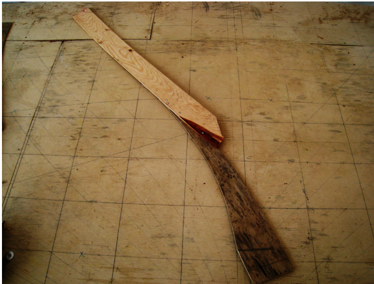
111. Χνάρι νομέα του πρυμνιού τμήματος του σκάφους
