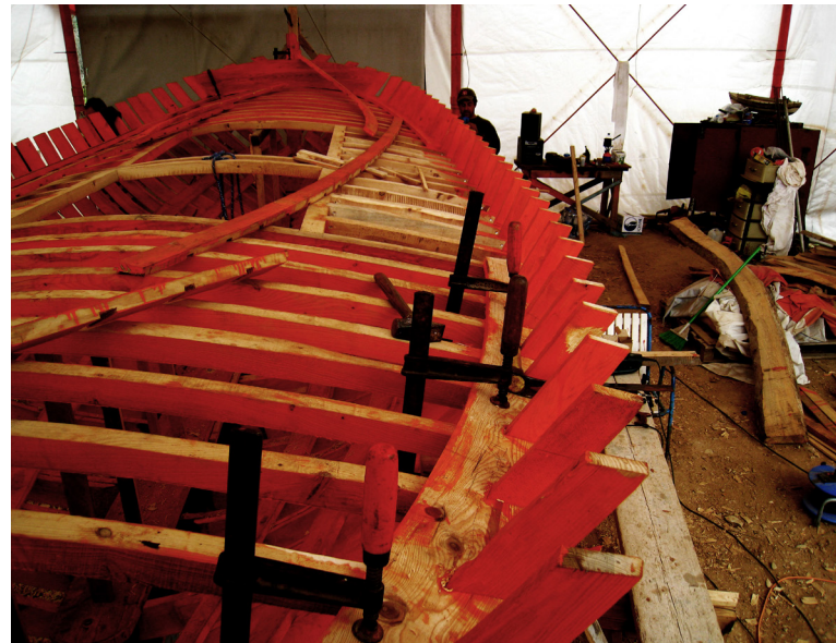
149. Η κατωκουραστή αφαιρείται για να τοποθετηθεί το τρυπητό
