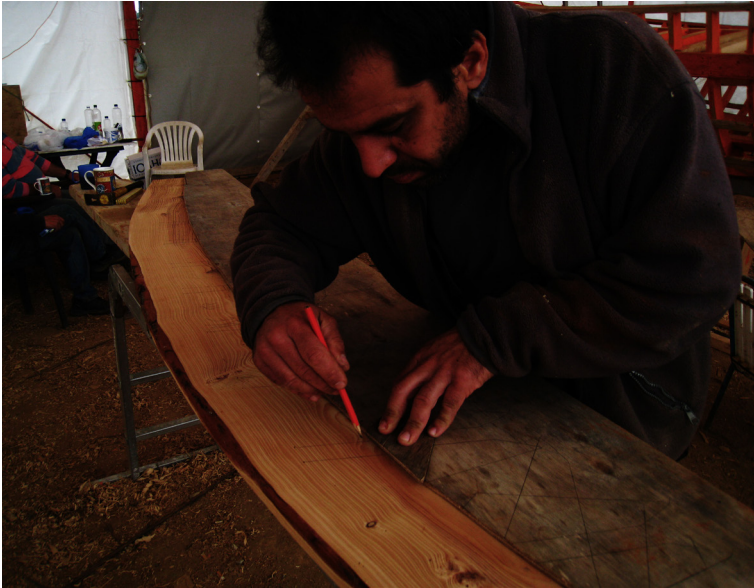
146. Αποτύπωση του σχήματος και των οπών του τρυπητού με τη στατζόλα και το μασταρί
