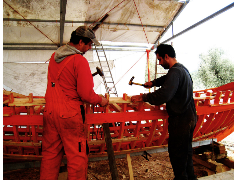
148. Τοποθέτηση του τρυπητού μέσα από τις απολήξεις των νομέων
