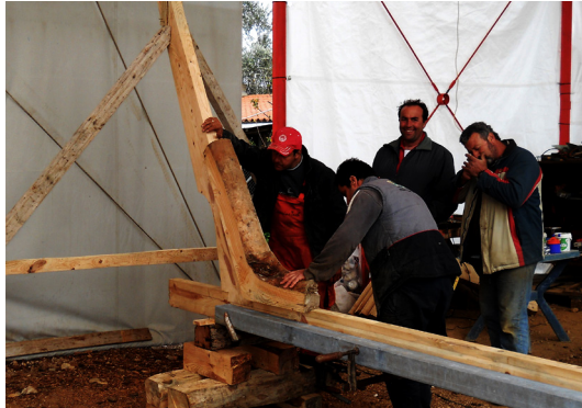
97. Το ξύλο που θα αποτελέσει το πρυμνιό ποδόσταμο έχει σχήμα φυσικού μπρατσολιού
