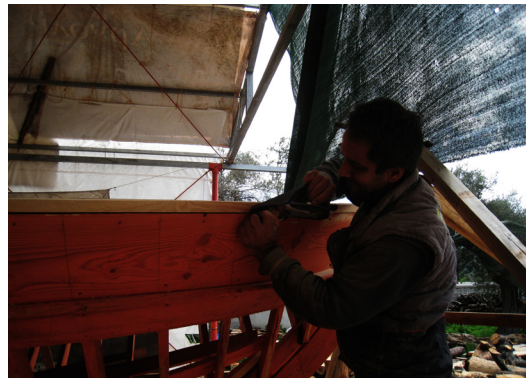
166. Ροκάνισμα της εξωτερικής επιφάνειας της κουπαστής
