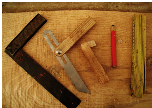
17. Εργαλεία μετρήματος και σημαδέματος - γωνιά, στέλα, μέτρο
