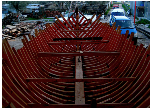
124. Ο σκελετός του σκάφους βαμμένος με μίνιο
