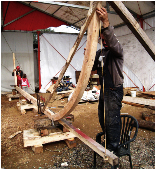
93. Έλεγχος της κατακορυφότητας του πλωριού ποδοσταμάτος με το νήμα της στάθμης
