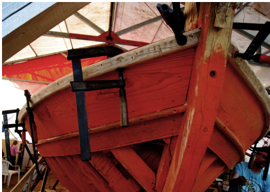
170. Τα ζωνάρια του πλωριού τμήματος
