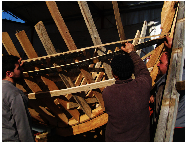
114. Επί τόπου διαμόρφωση του χναριού των πλωριών πρωτοβαθικών
