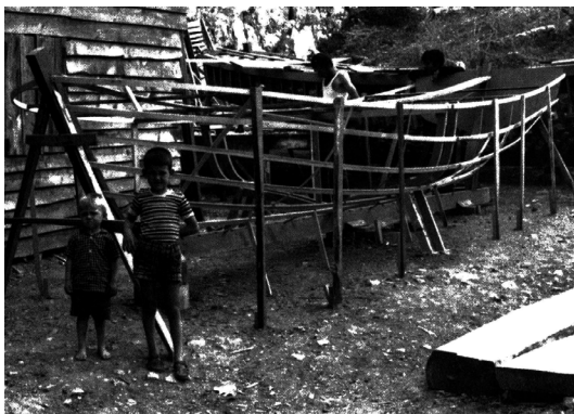
108. Βάρκα ναυπηγούμενη με τη μέθοδο 'μεσαίας νομείας και φούρμες. Πηγή: Δαμιανίδης (1998) σ. 139
