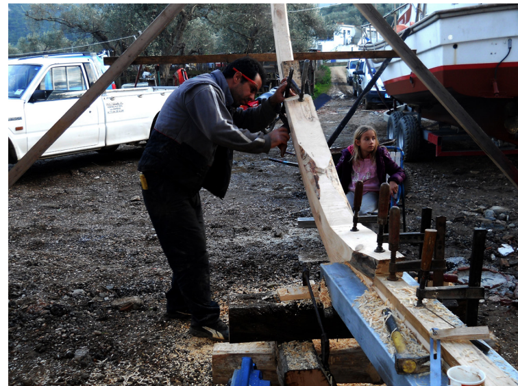
96. Το ξύλο που θα αποτελέσει το πλωριό σόψωμο πρέπει να έχει φυσική καμπυλότητα τέτοια, ώστε οι ίνες του να ακολουθούν την ιδιαίτερη καμπύλη του πλωριού ποδοσταμάτος
