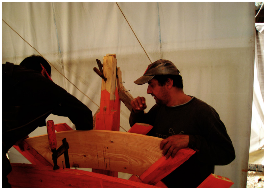
161. Κατασκευή των ψηλών καμαριών της πρύμνης
