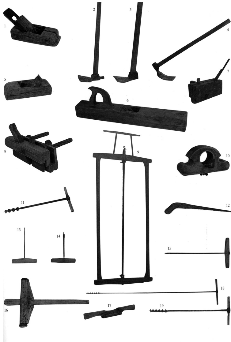
22. Εργαλεία ναυπηγικής: (1) στραβορόκανο, (2) σκεπαρνιά με τζιτζικα, (3) σκεπαρνιά σκύλα, (4) σκεπαρνιά κατοσόνα, (5) ροκάνι στενό, (6) χειροπλάνη, (7) και (8) κινίσι ή γκινόσος, (9) πιοκί, (10) τζινιαδόρος, (11) καράβολα, (12) σμίνη ή σβανάς, (13) προκοτρύπανο, (14) πετοστρύπανο, (15) τζαβετοτρύπανο. (16) ματσόλα καλαφατίσματος, (17) παστράγκουλο, (18) αρίδα, (19) καρόβιδα. Πηγή: Ναυτική παράδοση στο Αιγαίο (1997) σ. 65
