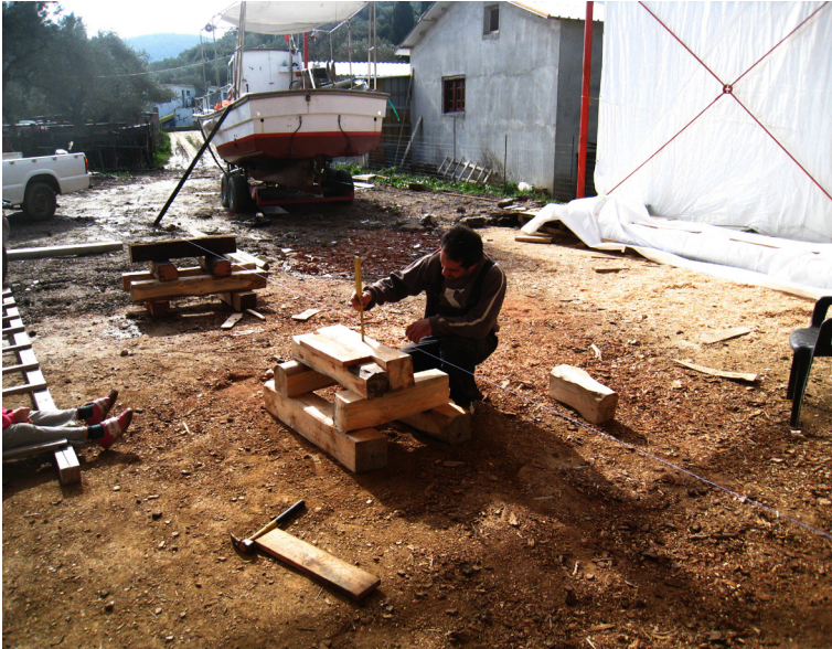
83. Κατασκευή των 'τάκων' πάνω στους οποίους θα στηριχθεί η καρίνα του σκάφους
