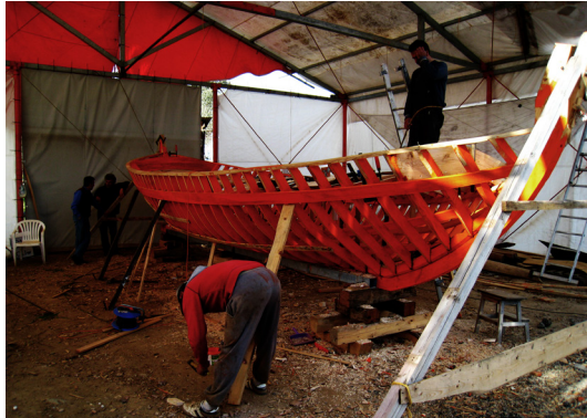
145. Ζύγισμα του καϊκιού με πλευρικά μπουντέλια
