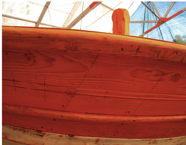
160. Το σχέδιο που χαράσσεται στο αστάρι της κουπαστής.
