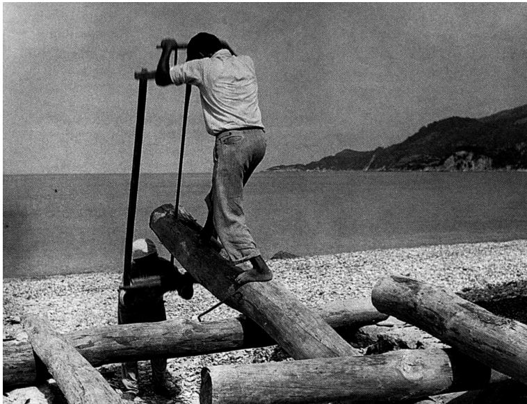
23. Κόψιμο ξύλων από τους ποικιζήδες με πικιά στη Σάμο, 1955. Πηγή: Ναυτική παράδοση στο Αιγαίο (1997) σ. 64
