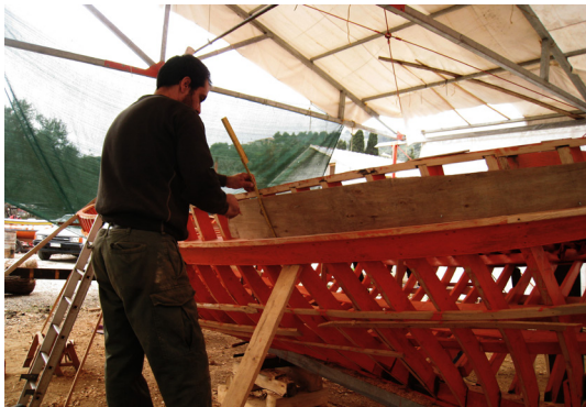
156. Μια παραλλαγή της μεθόδου σταιζόλα και μασταρί. Στη σταιζόλα καταγράφεται το ύψος του παραπέτου σε κάθε νομέα
