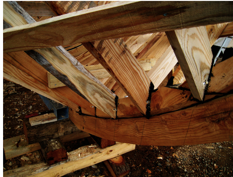
113. Οι νομέες του πλωριού τμήματος, στερεωμένοι πάνω στο σώψωμο
