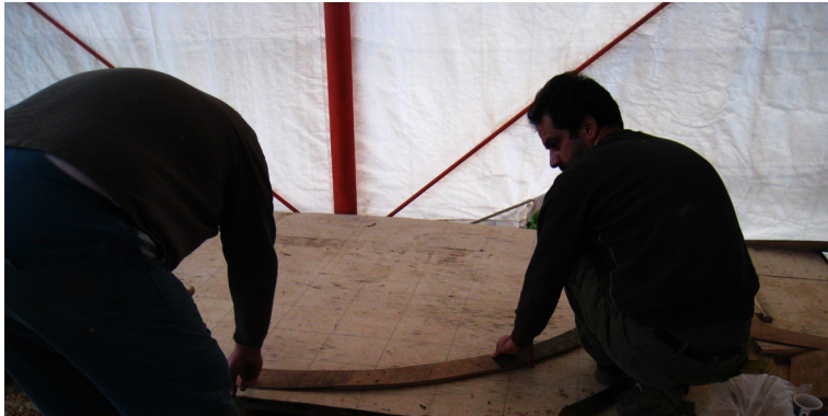
101. Δημιουργία του χναριού με το οποίο θα βρεθεί και θα σημαδευτεί το κατάλληλο ξύλο
