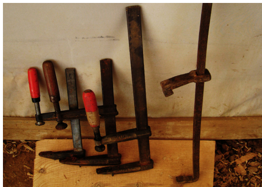
18. Εργαλεία κρατήματος και σφιξίματος - σφιγκτήρες και νταβίδι
