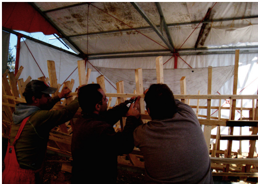
121. Τοποθέτηση της φούρμας της κουπαστής
