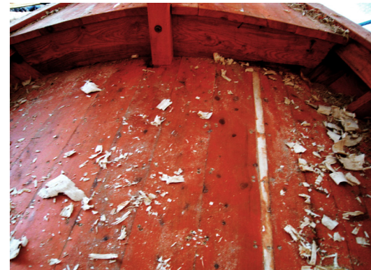
155. Το πλωριό τμήμα της κουβέρτας όπου φαίνεται το λεπτό σανίδι που προστέθηκε για να σφίξει τα μαδέρια μεταξύ τους
