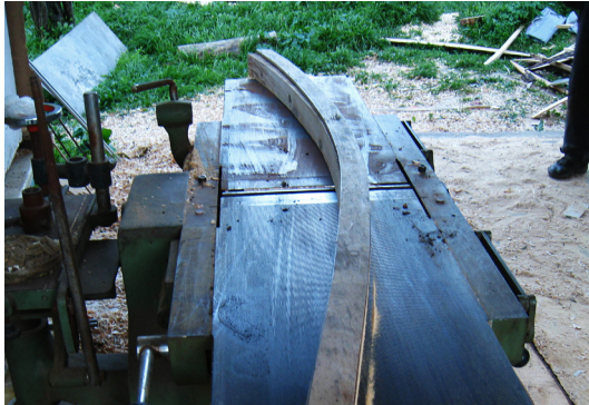
37. Κομμένο στραβόξυλο που έχει 'πετοικάρει', δηλαδή έχει σκευρώσει ελαφρά, όπως φαίνεται συγκρινόμενο με το χνάρι του
