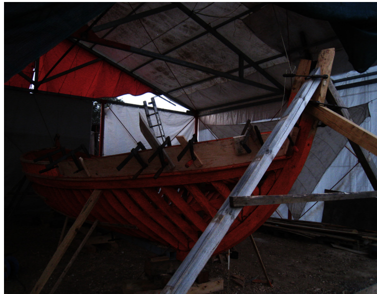
159. Το πλωριό αστάρι στερεωμένο με σφιγκτήρες
