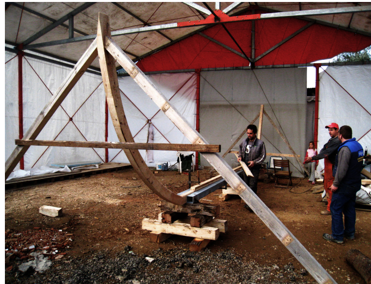
95. Το σύμπλεγμα καρίνας-ποδοσταμάτων έχει ακινητοποιηθεί στο χώρο με τη βοήθεια ισχυρών μπουντελιών. Επιπλέον, μεταλλικοί κοιλοδοκοί ενισχύουν την καρίνα
