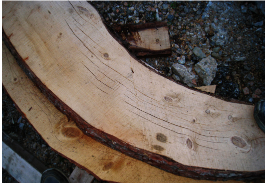
36. Στραβόξυλο που έχει ρυγματοωθεί, κατά μήκος των ινών του, λόγω της απευθείας έκθεσης στον ήλιο
