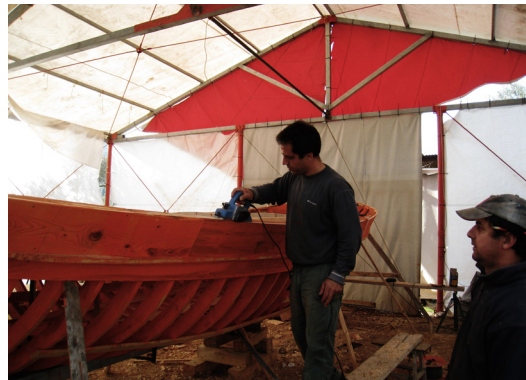
164. Πλάνισμα της τελικής επιφάνειας κάτω από την κουπαστή
