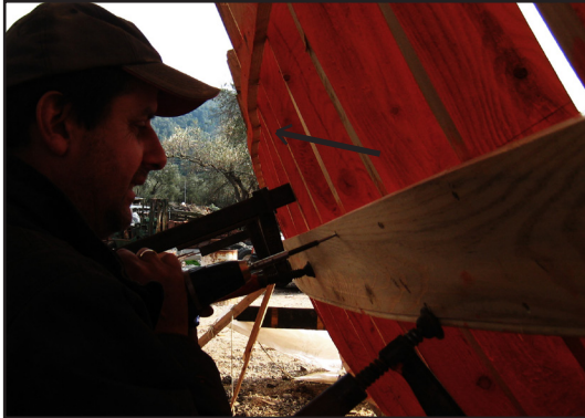
133. Η τσάπα πριν την τοποθέτηση της κατωκουραστίς
