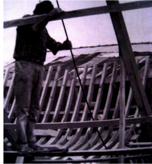
109. Χρήση ούρματος για τον καθορισμό του σχήματος ενός πλωριού νομεία. Πηγή: Δαμιανίδης (1998) σ. 189
