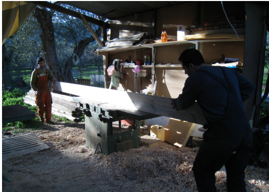
116. Κόψιμο και πλάνισμα του επιλεγμένου μαδεριού
