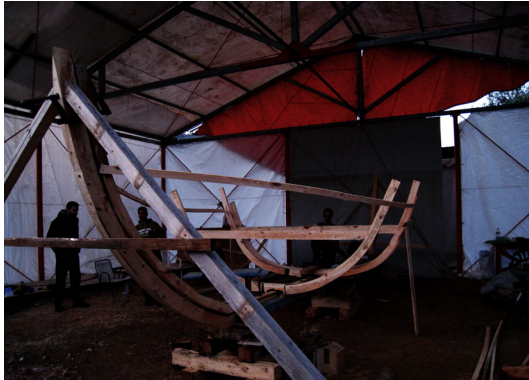
106. Οι φούρμες τοποθετούνται ήδη από πολύ αρχικό στάδιο
