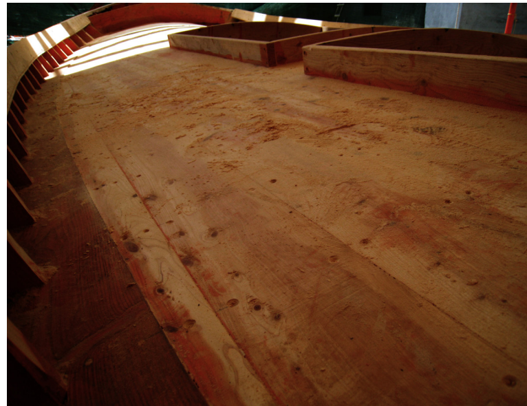
154. Η κουβέρτα ολοκληρωμένη. Φαίνεται το ακριανό μαδέρι που 'κλειδώνει' την κουβέρτα
