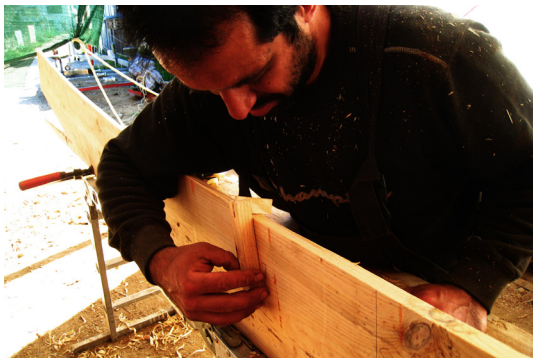
158. Μεταφορά της γωνίας με τη στέλα, και δημιουργία του απαραίτητου φάλτου με το ροκάνι
