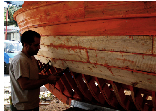
181. Ύστερα λυγίζουν επάνω στους νομείς με βοήθεια σφιγκτήρων
