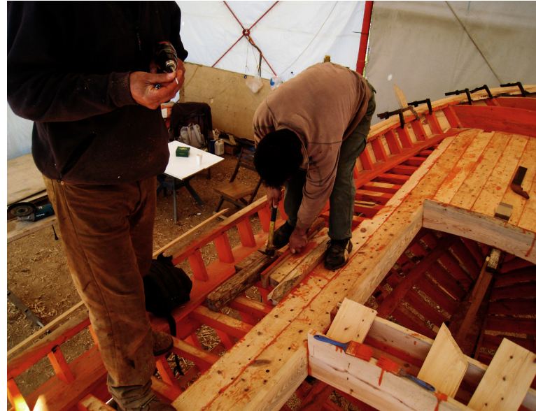
153. Οι σφήνες με τις οποίες σφίγγουν μεταξύ τους τα μαδέρια πριν βιδωθούν
