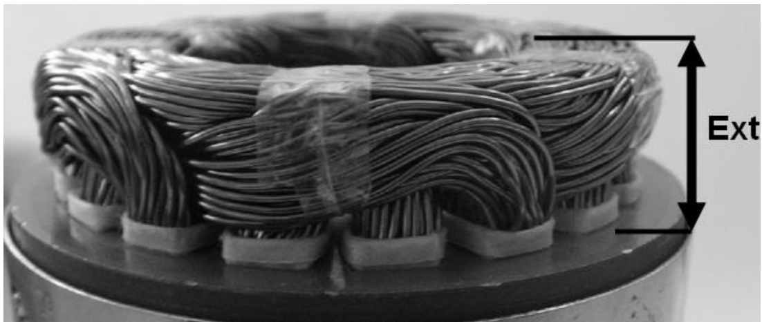
Σχήμα 3.12: Άκρα διανεμημένου τυλίγματος [25].
