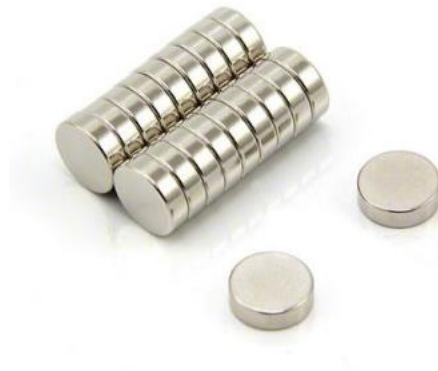
Σχήμα 2.6: Συστοιχίες κυλινδρικών μαγνητών τύπου NdFeB [4].
