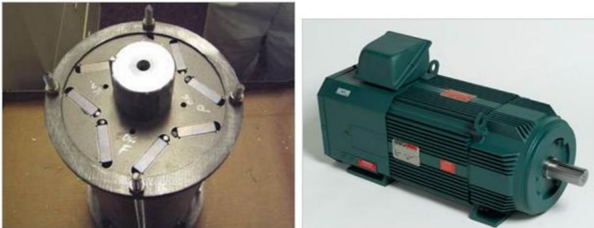
Σχήμα 2.10: Μηχανή IPM για τομή ξύλου σε πριονιστήριο [7].
