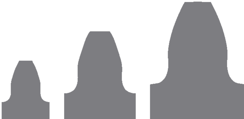
Σχήμα 6.1. Οδόντες με m=2 , m=3 , m=4
