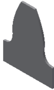
Σχήμα 6.2. Οδόντας πλάτους b_1=0.1\text{m}
