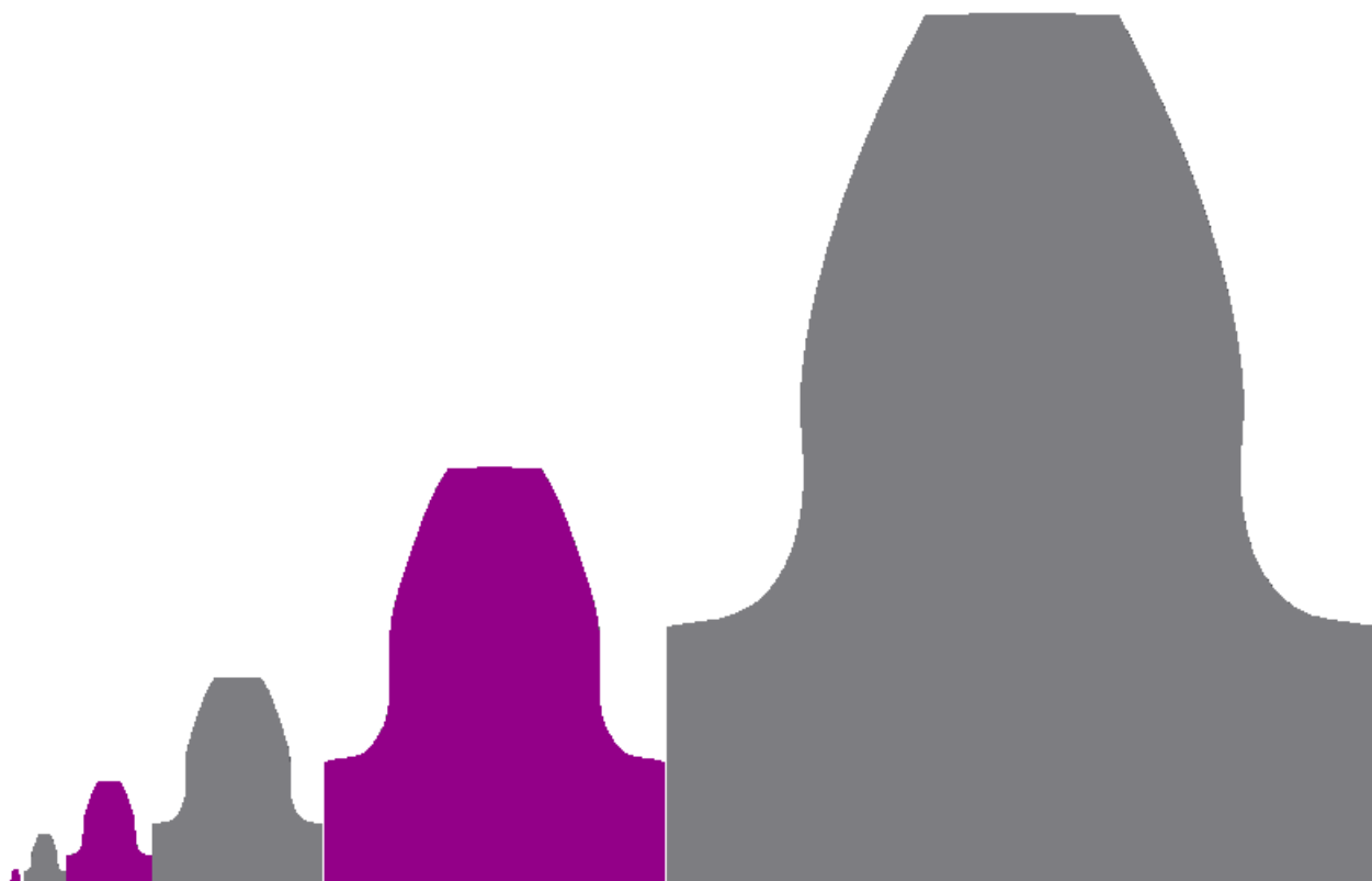
Σχήμα 5.13. Οδόντες με m=1 , m=3 , m=6 , m=12 , m=24 , m=50 mm
