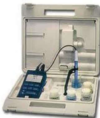
Εικόνα 3.2 Συσκευή μέτρησης pH WTW 315i
