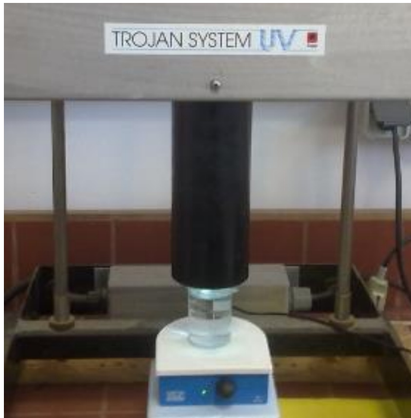
Εικόνα 3.5 Συσκευή υπεριώδους ακτινοβολίας Trojan System UV 4000
