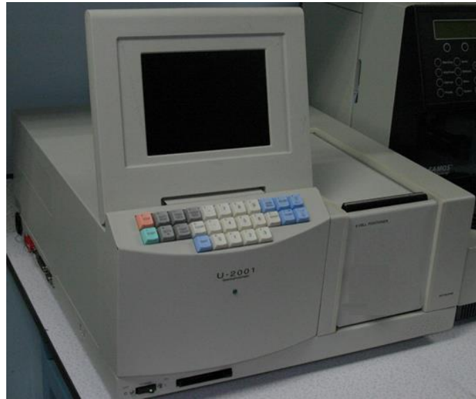
Εικόνα 3.1 Φασματοφωτόμετρο Hitachi U 2001 UV/VIS Spectrophotometer για τη μέτρηση της διαπερατότητας (%T)
