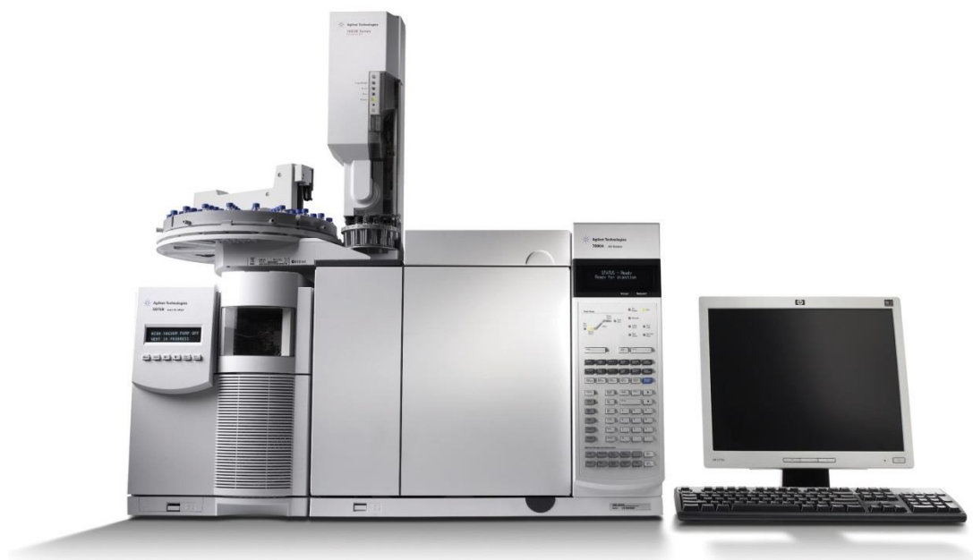
Εικόνα 3.9 Αέριος χρωματογράφος Agilent 7890A συζευγμένος με φασματογράφο μάζας Agilent 5975C
