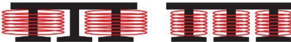
Σχήμα 3.9 Συγκεντρωμένο Τύλιγμα Απλής και Διπλής Στρώσης[22]
