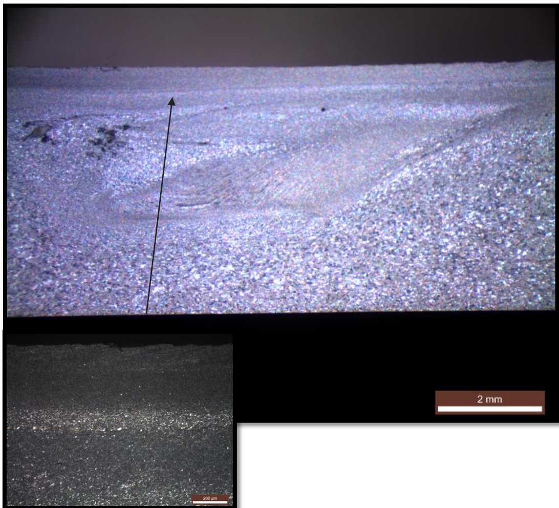
Εικόνα 2.8.16 Εικόνες στερεοσκοπίας και οπτικής μικροσκοπίας των εγκάρσιων διατομών που παρήχθησαν με τη χρήση εργαλείου FSP – Δοκίμιο 14
