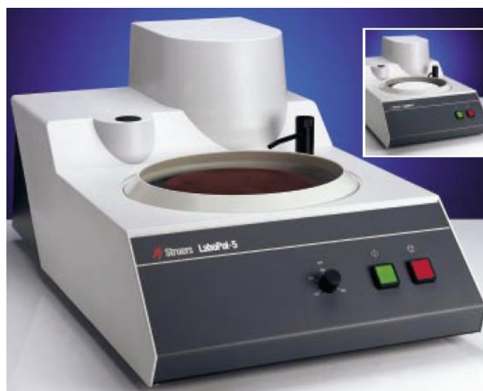
Εικόνα 2.2.5 Συσκευή λείανσης-στίλβωσης Struers LaboPol-5
