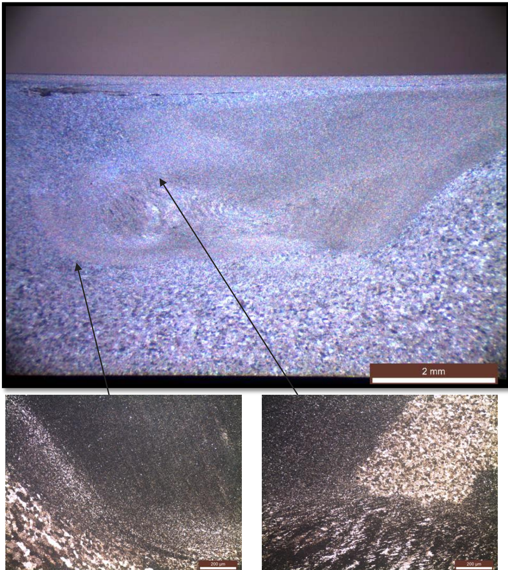
Εικόνα 2.8.11 Γεωμετρία αυλακίων που χρησιμοποιήθηκαν για την εισαγωγή της νανοσκόνης αλουμίνας στο δοκίμο 12
