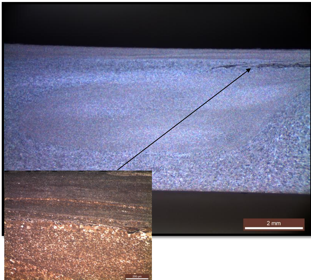
Εικόνα 2.7.13 Εικόνες στερεοσκοπίας και οπτικής μικροσκοπίας των εγκάρσιων διατομών που παρήχθησαν με τη χρήση εργαλείου FSP – Δοκίμιο 6
