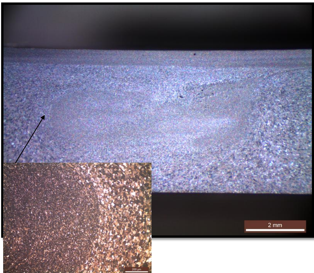
Εικόνα 2.7.6 Εικόνες στερεοσκοπίας και οπτικής μικροσκοπίας των εγκάρσιων διατομών που παρήχθησαν με τη χρήση εργαλείου FSP – Δοκίμιο 3
