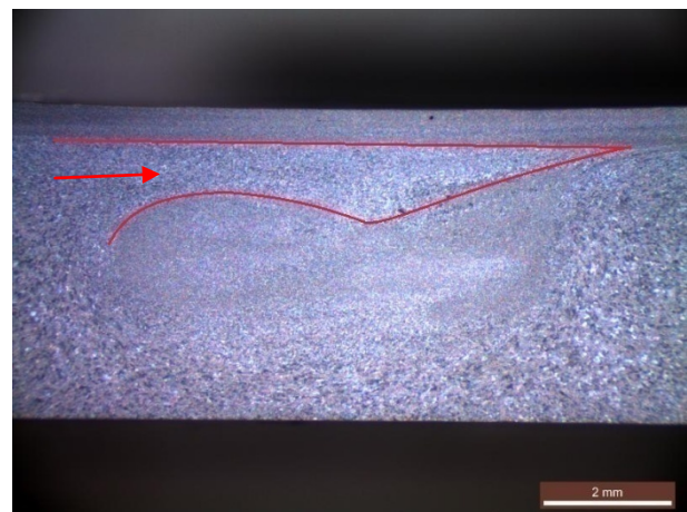
Εικόνα 2.7.16 Εικόνες στερεοσκοπίας εγκάρσιων διατομών που παρήχθησαν με τη χρήση εργαλείου FSP στις οποίες φαίνεται η εισαγωγή του “flow arm” στην ζώνη ανάδευσης.
