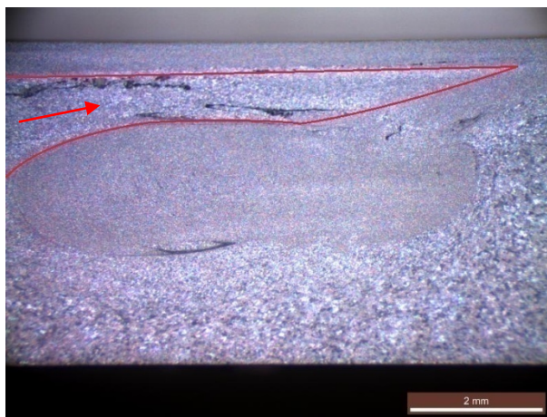
Εικόνα 2.7.16 Εικόνες στερεοσκοπίας εγκάρσιων διατομών που παρήχθησαν με τη χρήση εργαλείου FSP στις οποίες φαίνεται η εισαγωγή του “flow arm” στην ζώνη ανάδευσης.
