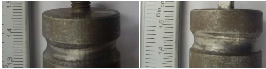
Εικόνα 2.2.2 Εργαλεία FSP που χρησιμοποιήθηκαν στην πειραματική διαδικασία.
