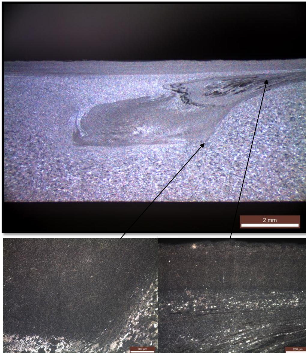
Εικόνα 2.8.13 Γεωμετρία αυλακίων που χρησιμοποιήθηκαν για την εισαγωγή της νανοσκόνης αλουμίνας στο δοκίμο 13
