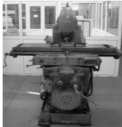
Εικόνα 2.2.1 Μηχανή κατεργασίας FSP
