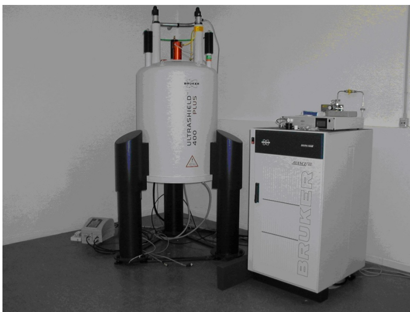
Εικόνα 27: Απεικόνιση της διάταξης μιας NMR κατασκευής
