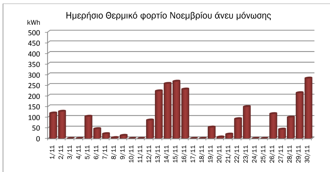
Γράφημα 3- 54 Ημερήσιο Θερμικό φορτίο Νοεμβρίου άνευ μόνωσης
