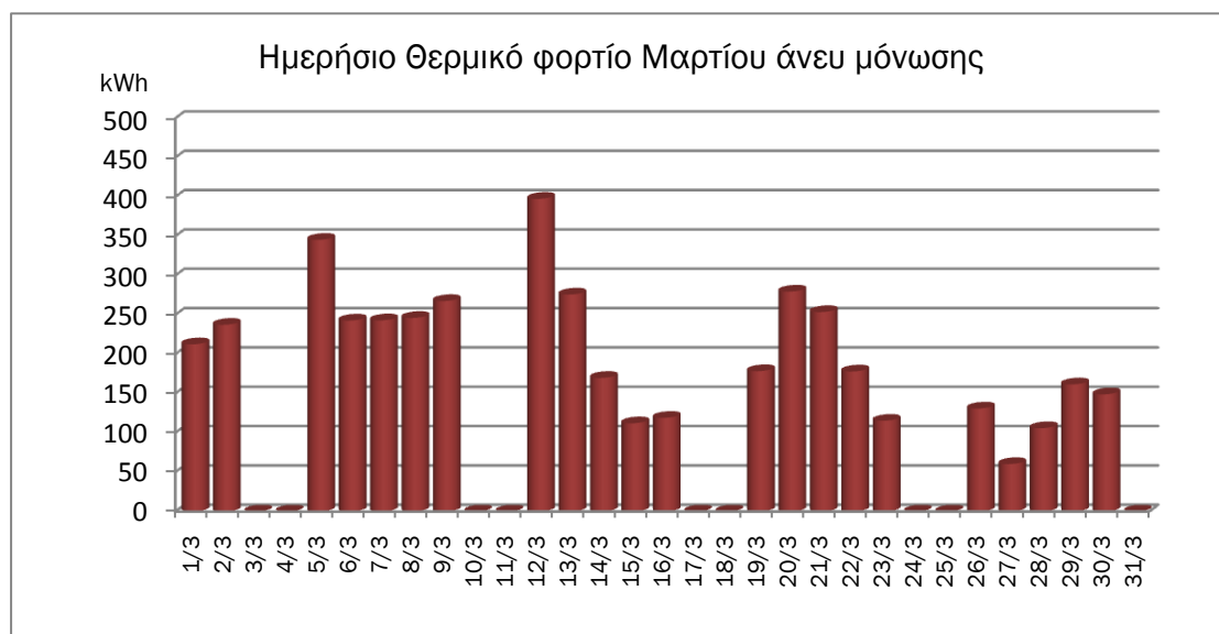
Γράφημα 3- 34 Ημερήσιο Θερμικό φορτίο Μαρτίου άνευ μόνωσης
