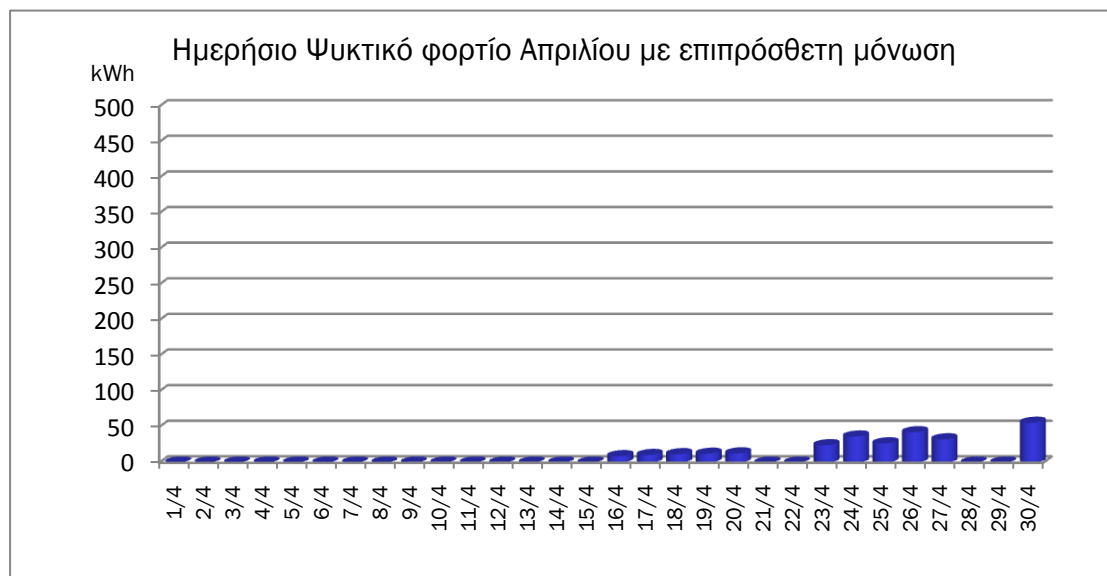
Γράφημα 3- 99 Ημερήσιο Ψυκτικό φορτίο Απριλίου με επιπρόσθετη μόνωση
