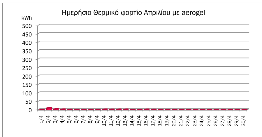
Γράφημα 3- 127 Ημερήσιο Θερμικό φορτίο Απριλίου με aerogel
