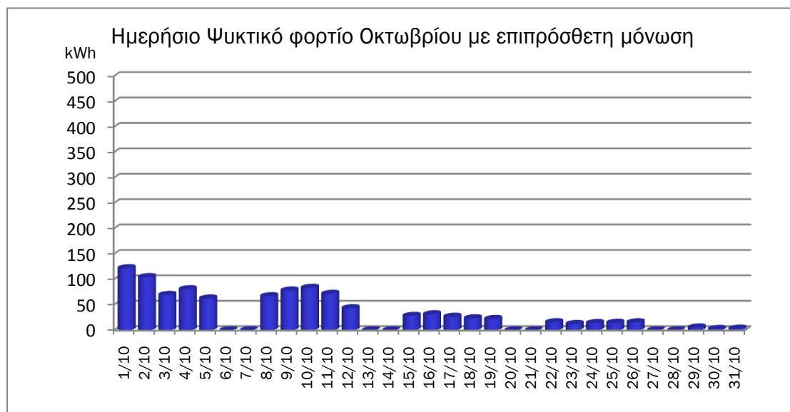
Γράφημα 3- 111 Ημερήσιο Ψυκτικό φορτίο Οκτωβρίου με επιπρόσθετη μόνωση
