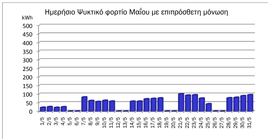
Γράφημα 3- 101 Ημερήσιο Ψυκτικό φορτίο Μαΐου με επιπρόσθετη μόνωση
