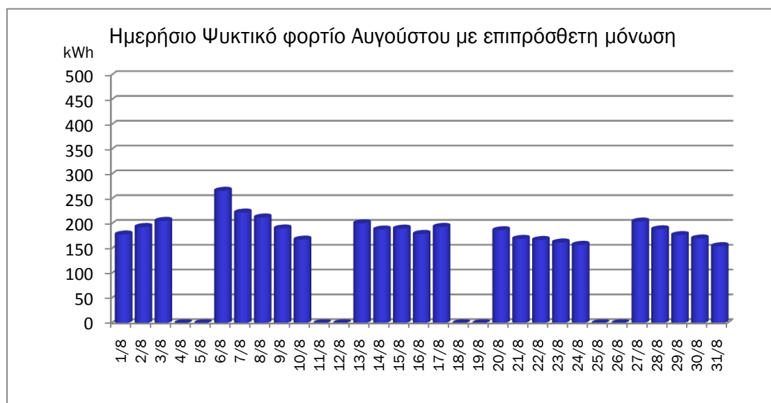
Γράφημα 3- 107 Ημερήσιο Ψυκτικό φορτίο Αυγούστου με επιπρόσθετη μόνωση
