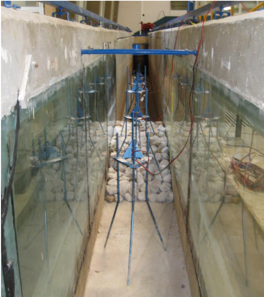
Εικ.4.7 Άποψη της πειραματικής διάταξης διαπερατού ύφालου κυματοθραύστη κατάντη αυτού.
