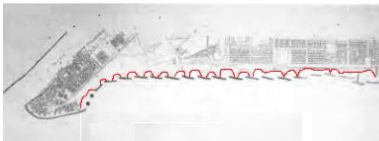
Σχ. 1.2 Πρακτική έξαλων αποσπασμένων κυματοθραυστών τη δεκαετία του 70 και δημιουργία tombolo (σημεινόμενα με κόκκινη γραμμή) στην Όστια, Δυτική Ιταλία.
