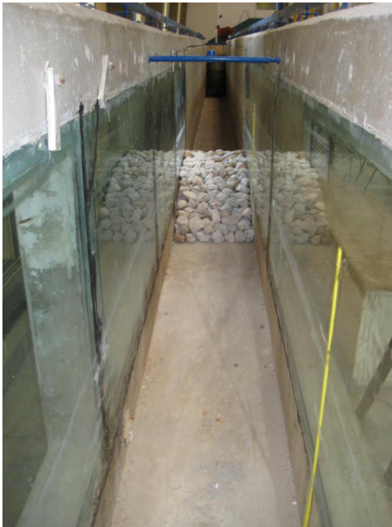
Εικ.4.1 Άποψη της πειραματικής διώρυγας και του φυσικού προσομοιώματος διαπερατού Υ.Κ. κατά τη φάση ανάπτυξης της διάταξης, από την πλευρά της κυματογεννήτριας.
