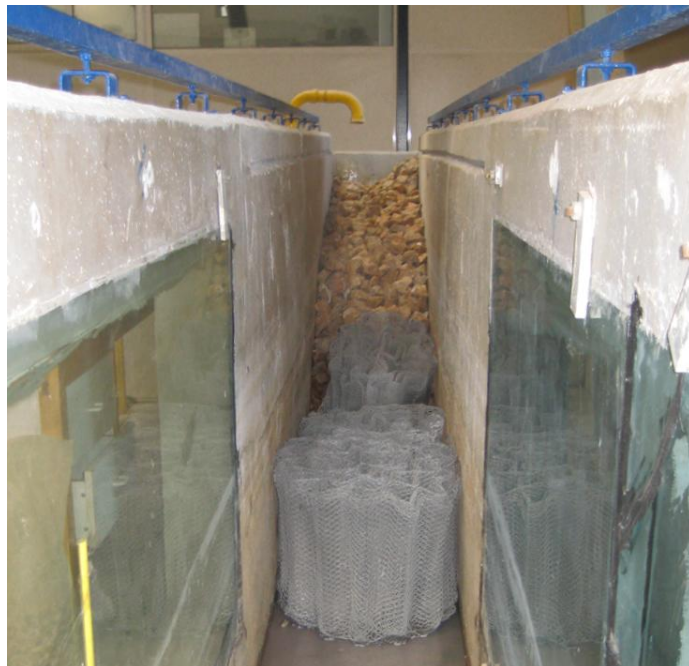
Εικ.4.10 Απορροφητικές στοιβάδες (sponge layers) κατόντη του ύφαλου κυματοθραύστη.
