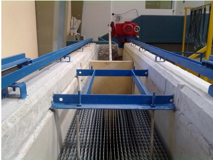
Εικ.4.3 Πτερύγιο κυματιστήρα και διάταξη διάτρητων πλακών ομαλοποίησης του κυματισμού.
