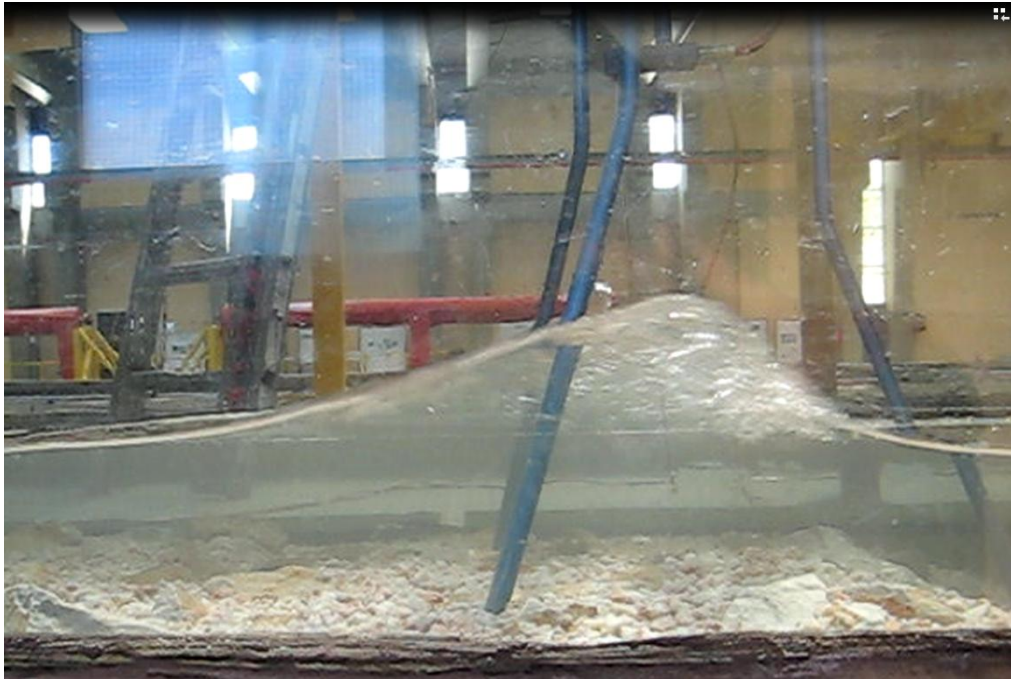
Εικ.4.9 Στιγμιότυπο εξέλιξης κυματικού σεναρίου πάνω από τη στέψη του αδιαπέρατου Υ.Κ. τύπου εκτινάξεως (βάθος νερού 0.50 m).
