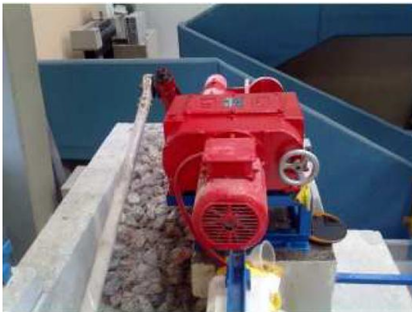
Εικ.4.2 Κυματογεννήτρια στο άκρο της διώρυγας τοποθετημένη σε βάθρο.
