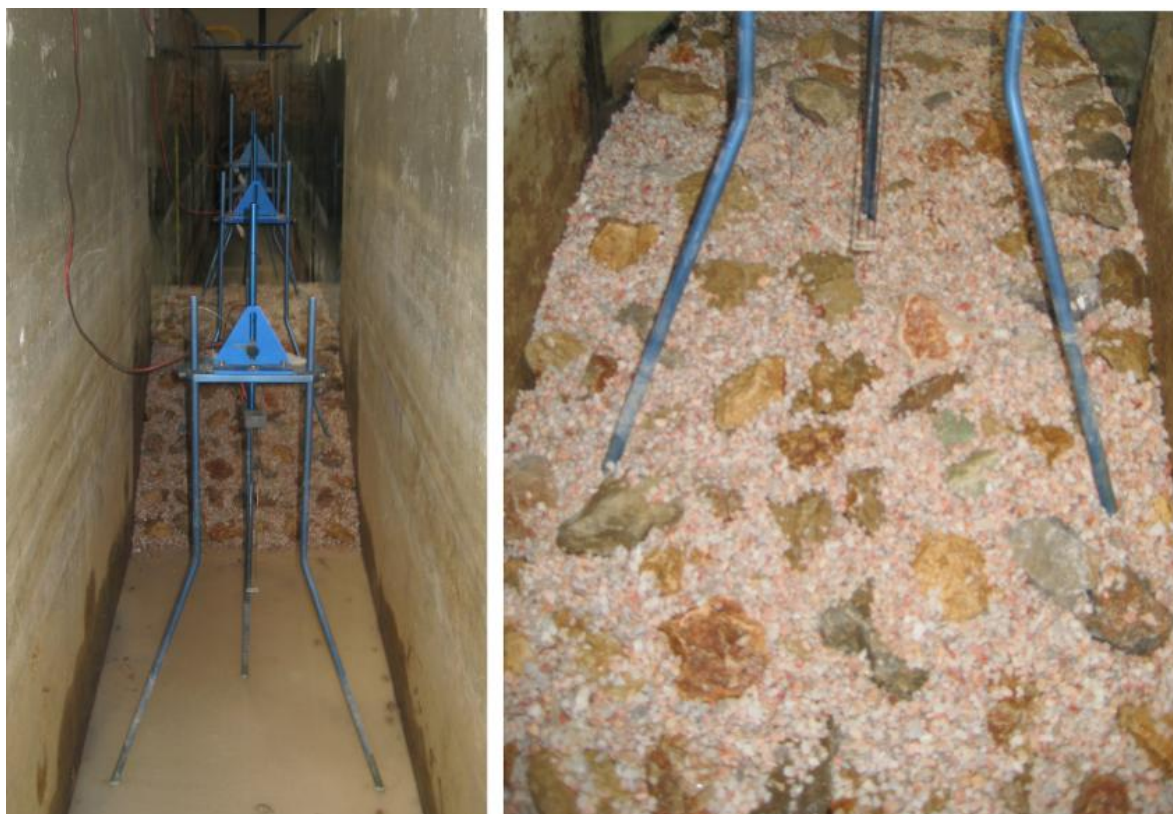
Εικ.4.8 Απόψεις της πειραματικής διάταξης αδιαπέρατου ύφαλου κυματοθραύστη.
