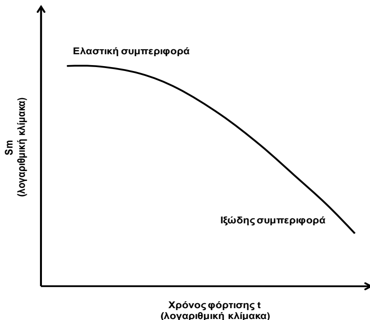
Εικόνα 2.5: Σχέση μεταξύ μέτρου δυσκαμψίας και χρόνου φόρτισης
