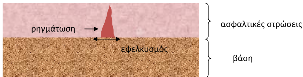
Εικόνα 2.8: Ρηγμάτωση τύπου bottom up
