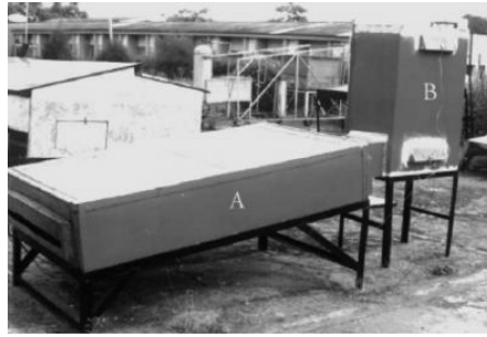
ΣΧΗΜΑ 9.13 Φωτογραφία του συστήματος θέρμανσης αέρα (Α) συσσωρευτικός συλλέκτης με αποθήκευση ενέργειας και υποσυστήματα θέρμανσης αέρα (Β) θερμαινόμενος χώρος [9]
