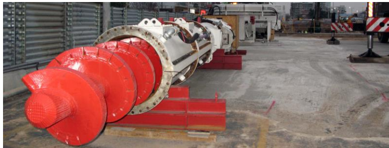
Εικόνα 5.3 Ατέρμονας κοχλίας του EPB-TBM του Μετρό Θεσσαλονίκης (Πηγή: Αττικό Μετρό ΑΕ)
