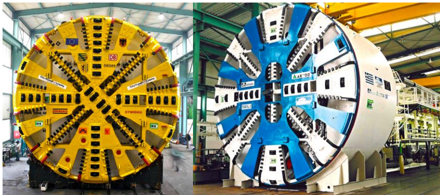
Εικόνα 2.1 Μηχάνημα με ασπίδα πολφού (αριστερά) και μηχάνημα με ασπίδα εξισορρόπησης εδαφικής πίεσης (δεξιά) (Πηγή: Αττικό Μετρό ΑΕ)
