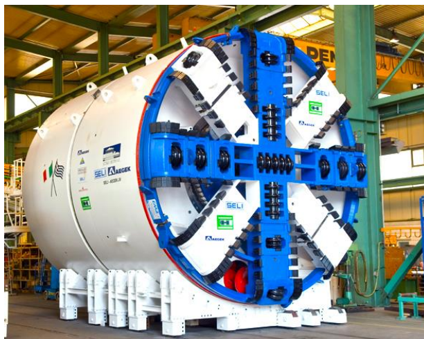
Εικόνα 5.1 Η κοπτική κεφαλή του EPB-TBM 2 του Μετρό Θεσσαλονίκης (Πηγή: Αττικό Μετρό Α.Ε.)
