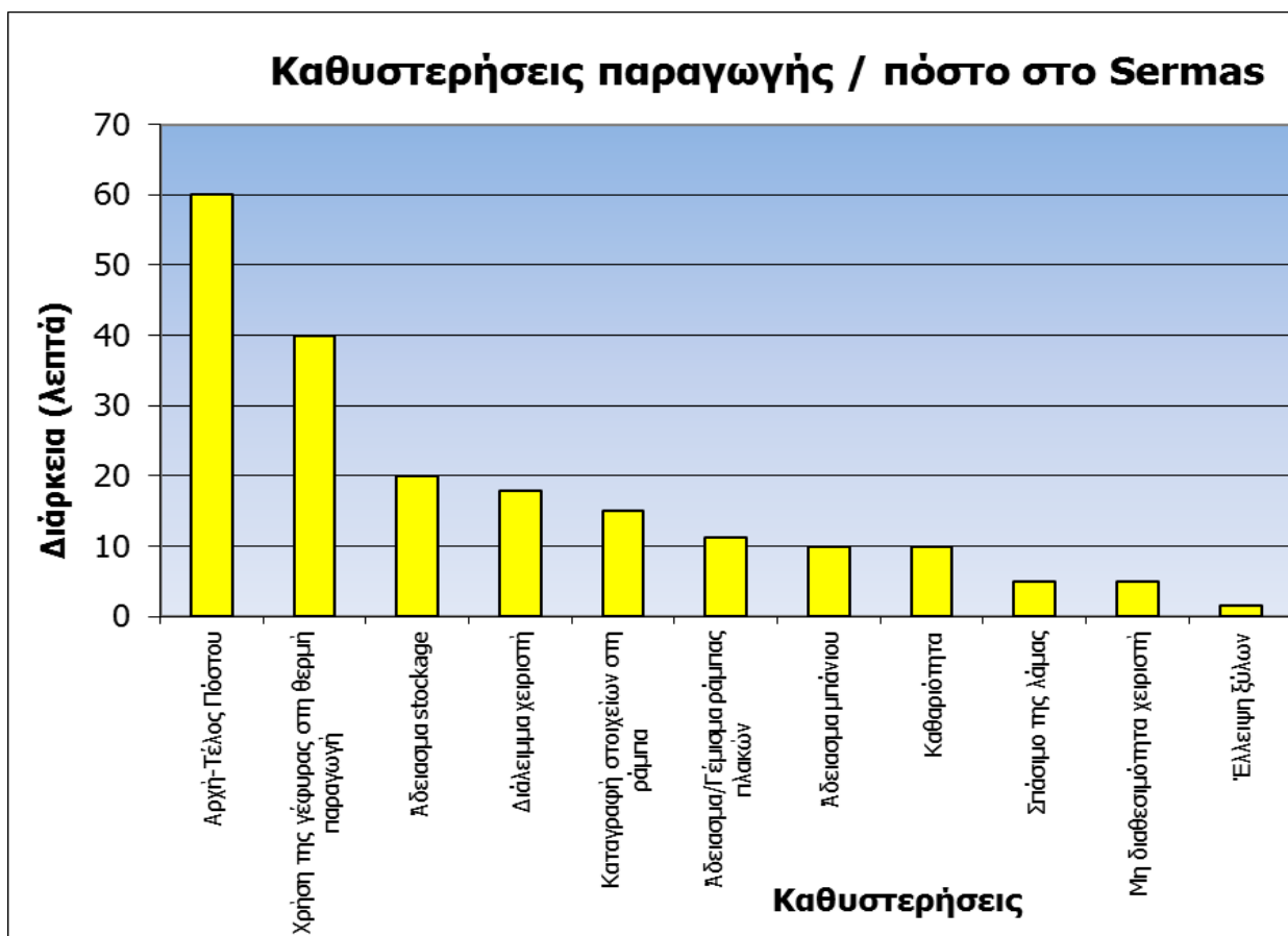
Εικόνα 5.8: Διάγραμμα κυριότερων καθυστερήσεων στη δεματοποίηση πλακών.
