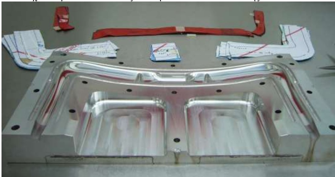
Εικόνα 68. Άνω μέρος καλουπιού (overlap) πριν ξεκινήσει η διαδικασία του layup. Στο πάνω μέρος της φωτογραφίας φαίνονται τα πατρόν όπως έχουν κοπεί, τοποθετημένα σύμφωνα με το stacking sequence
