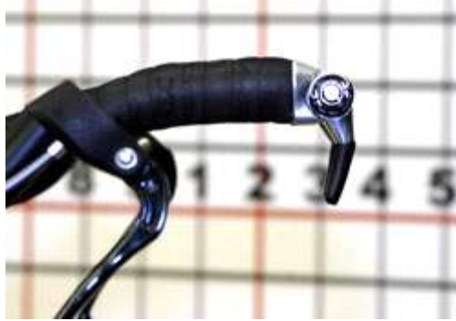
Εικόνα 11.Χρήση προεκτάσεων S-bend. Τα διακοπτάκια ταχυτήτων λαμβάνουν άβολες θέσεις.
