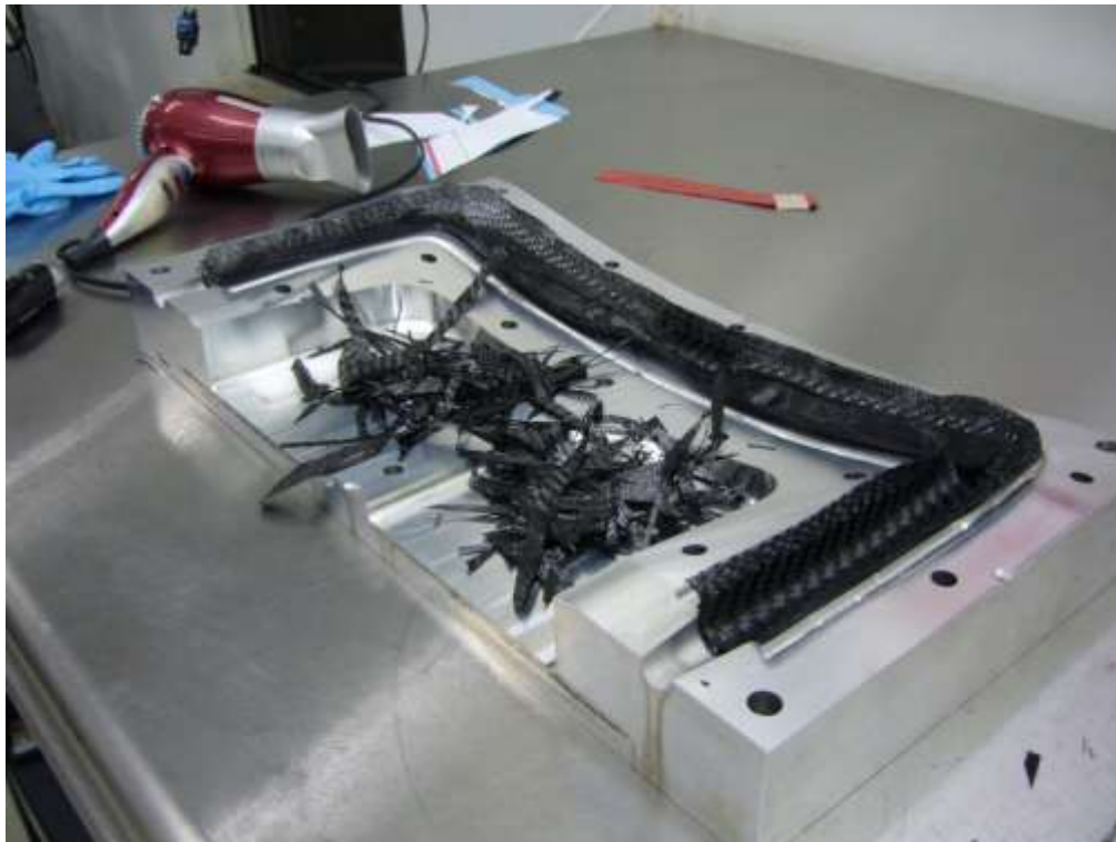
Εικόνα 72. Άνω μέρος καλουπιού με όλο το υλικό τοποθετημένο. Full stacking sequence
