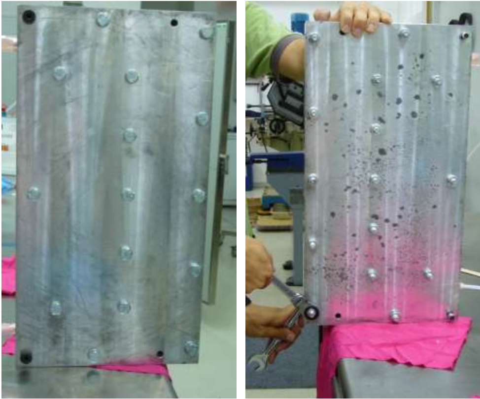
Εικόνα 75. Τοποθέτηση & σύσφιξη πείρων και βιδών Το πνευματικό κύκλωμα που δημιουργήθηκε φαίνεται παρακάτω
