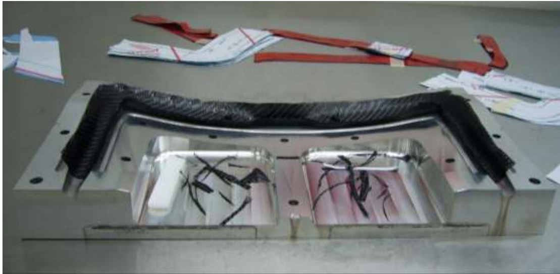
Εικόνα 69. Τοποθέτηση πρώτης στρώσης overlap, woven \pm 45^\circ
