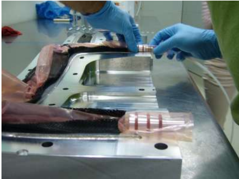
Εικόνα 73. Τοποθέτηση εσωτερικών σακούλων πίεσης
