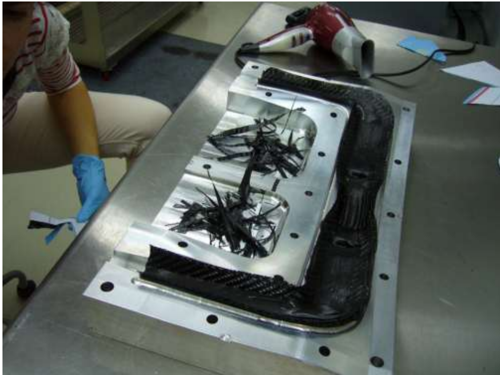
Εικόνα 70. Τοποθέτηση τρίτης στρώσης unidirectional 0^\circ
