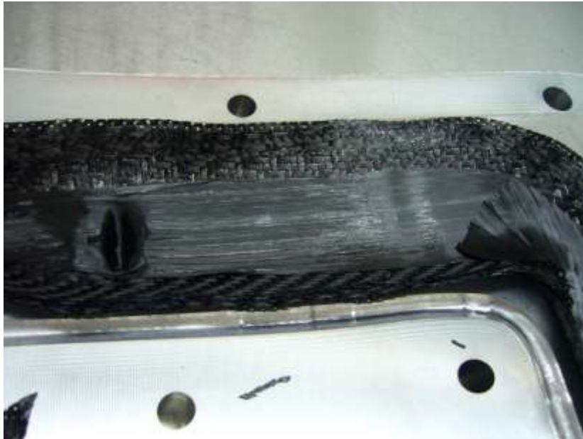
Εικόνα 71. Λεπτομέρεια overlap . Φαίνεται το διαδοχικά μειούμενο βήμα
