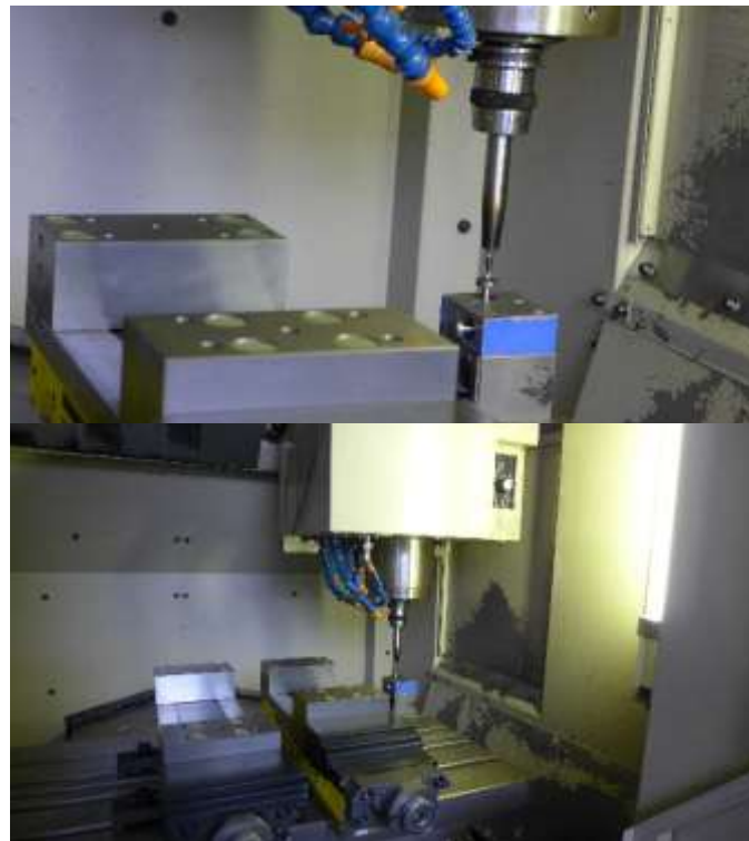
Εικόνα 50. Αντιστάθμιση κοπτικών εργαλείων
