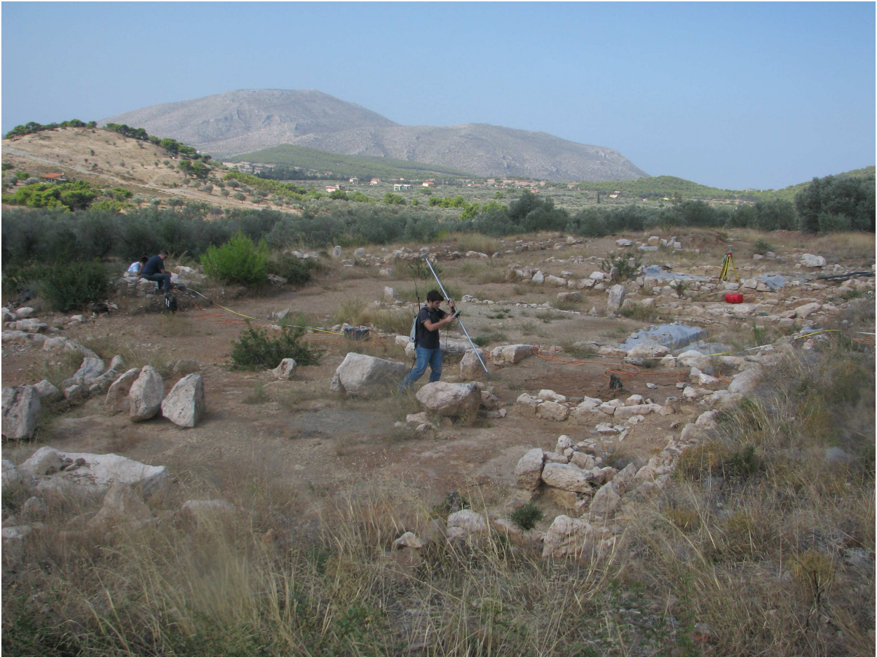
Εικόνα 6.27: Αποτύπωση αρχαιολογικού χώρου με διαφορικό GPS και μετρήσεις ηλεκτρικής αντίστασης.
