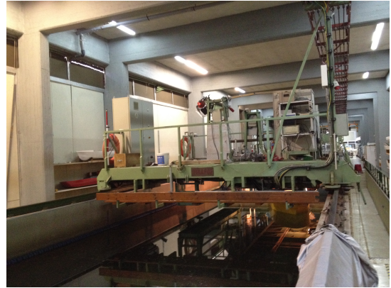
Σχήμα 2.5: Φορείο μεταφοράς των προτύπων στην δεξαμενή
