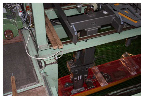
Σχήμα 2.3: Το δυναμόμετρο R-47 εδρασημένο στο φορείο που κινεί το μοντέλο
