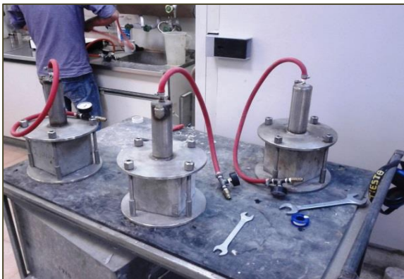
Εικόνα 15: Διάταξη μέτρησης της υδατοπερατότητας, πριν την εφαρμογή της πίεσης.
