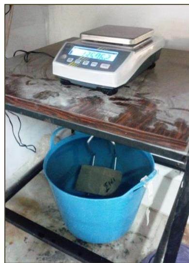
Εικόνα 6: Ζύγιση κορεσμένου δοκιμίου υπό άνωση.
