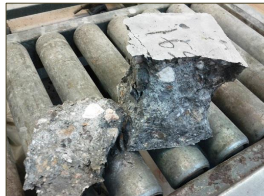
Εικόνα 29: Θραύση δοκιμίου Σ165.
