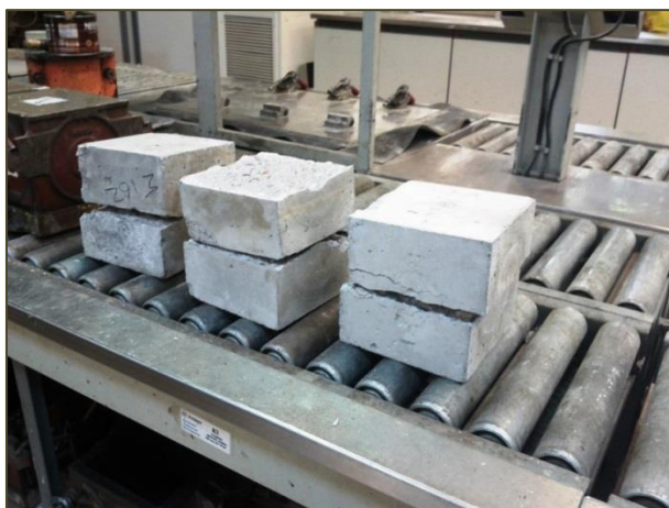
Εικόνα 18: Δοκίμια μετά τη διάρρηξή τους.
