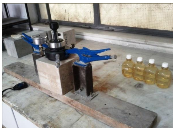
Εικόνα 10: Διεξαγωγή πειράματος υδατοπερατότητας.
