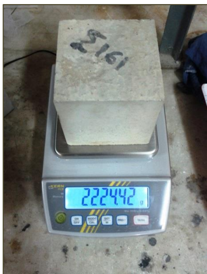
Εικόνα 5: Ζύγιση κορεσμένου δοκιμίου σε περιβάλλον αέρα.
