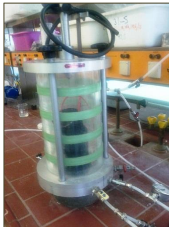
Εικόνα 24: Τοποθέτηση του περιβλήματος της κυψέλης.
