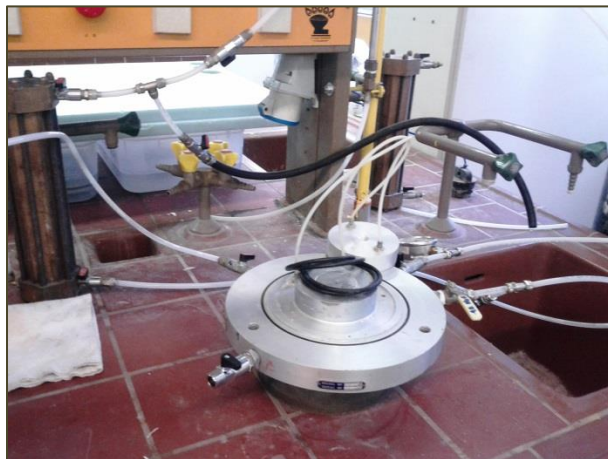
Εικόνα 19: Βάση της τριαξονικής κυψέλης και ελαστικοί δακτύλιοι.
