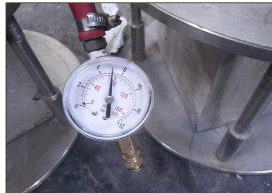
Εικόνα 16: Εφαρμογή πίεσης ίσης με 5 bar.
