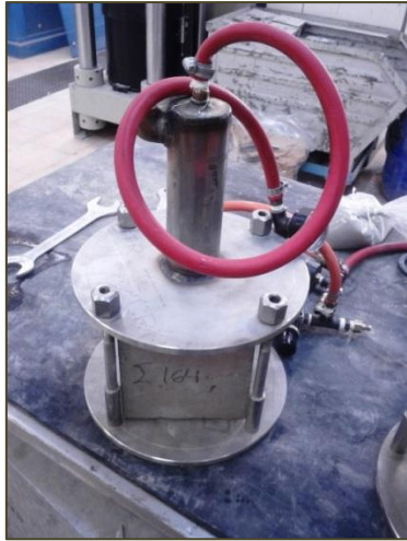
Εικόνα 11: Διάταξη για τον προσδιορισμό της υδατοπερατότητας.
