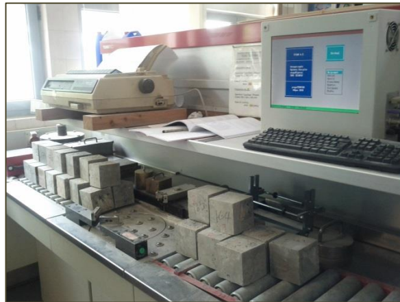
Εικόνα 26: Δοκίμια για τον προσδιορισμό της θλιπτικής αντοχής.
