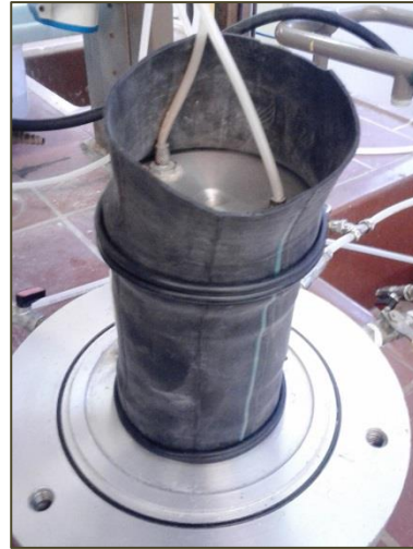
Εικόνα 23: Τοποθέτηση πορόλιθων, δοκιμίου, μεταλλικής πλάκας και των άνω 2 ελαστικών δακτυλίων.
