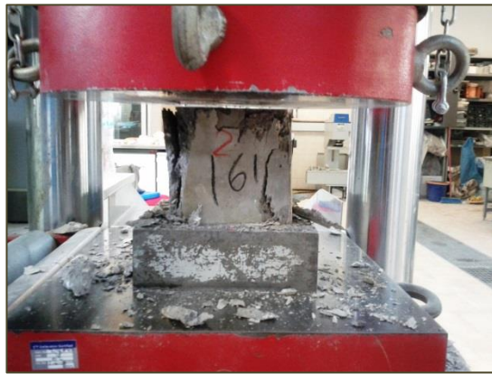
Εικόνα 27: Θραύση δοκιμίου Σ161.
