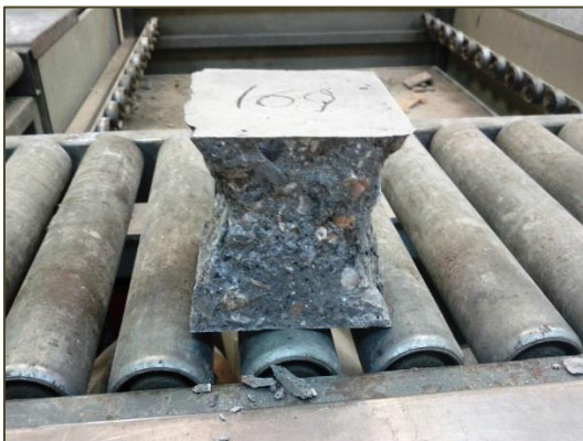
Εικόνα 28: Τυπική μορφή θραύσης δοκιμίου σε θλίψη.
