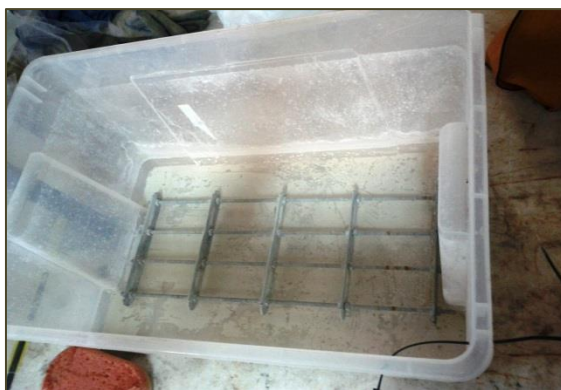
Εικόνα 2: Πλαστική δεξαμενή νερού και ανοξείδωτη μεταλλική βάση.
