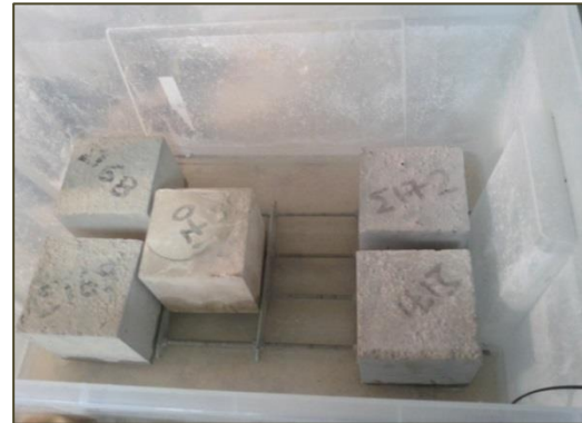
Εικόνα 4: Διεξαγωγή πειράματος τριχοειδούς απορρόφησης – 2 η ομάδα συνθέσεων.
