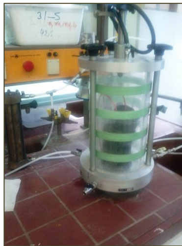
Εικόνα 20: Περίβλημα της τριαξονικής κυψέλης.
