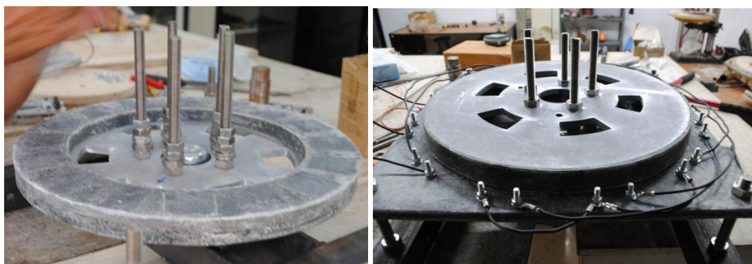
Σχήμα 8.12. Η γεννήτρια συναρμολογείται και ρυθμίζεται το διάκενό της ώστε να προσεγγίζει όσο το δυνατόν περισσότερο τις σχεδιαστικές προδιαγραφές.
