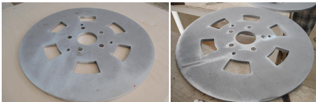
Σχήμα 8.1. Οι δύο δίσκοι του δρομέα μετά την κοπή λέιζερ
