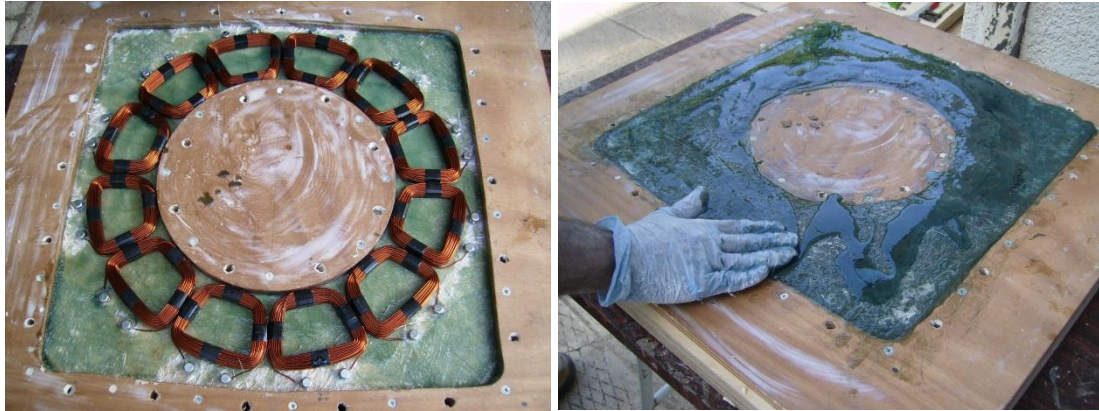
Σχήμα 8.10. Έγχυση ρητίνης στο καλούπι του στάτη
