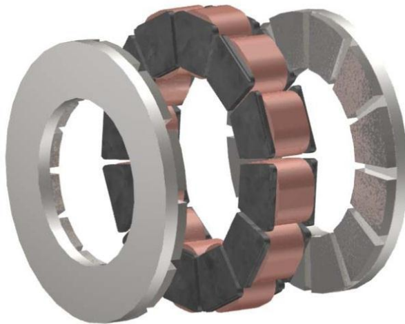
Σχήμα 2.3. Στάτης χωρίς πυρήνα
