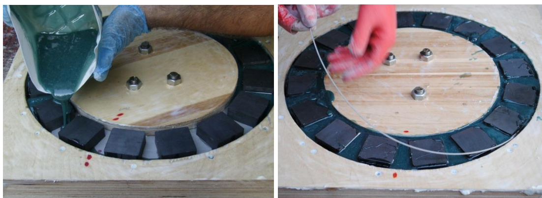
Σχήμα 8.4. (α) Έγχυση ρητίνης στο καλούπι, (β) Τοποθέτηση σύρματος γύρω από τους μαγνήτες.
