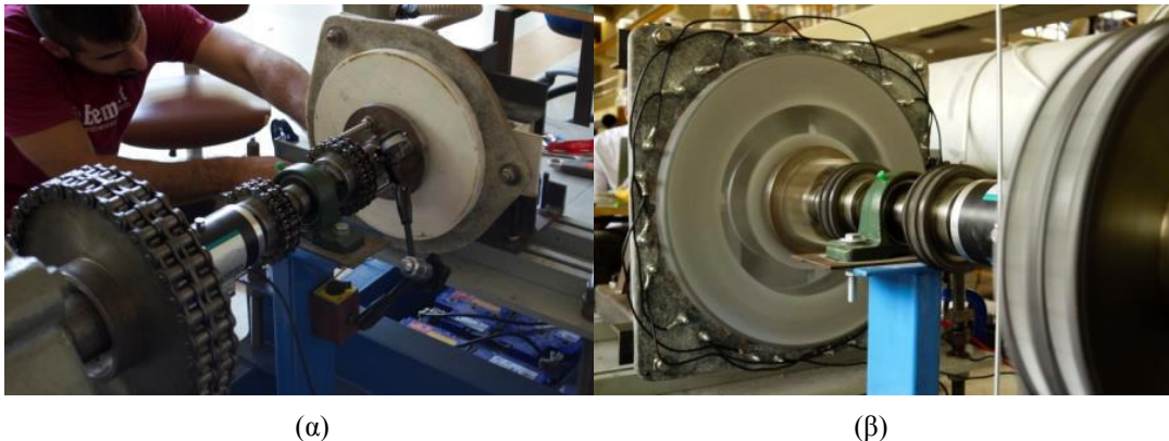
Σχήμα 8.14. (α) Η γεννήτρια νεοδυμίου 850W και (β) η αρκετά μεγαλύτερων διαστάσεων γεννήτρια με φερρίτες 850W.
