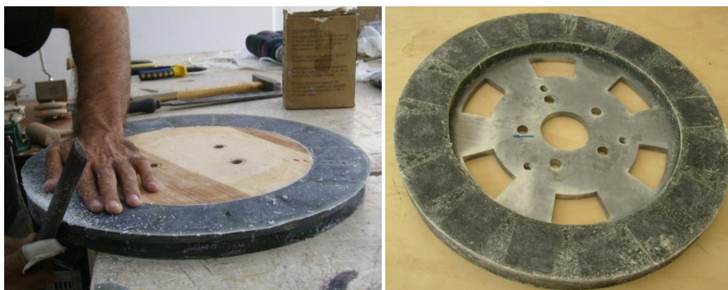
Σχήμα 8.6. (α) Απομάκρυνση της περιττής ρητίνης με λίμα, (β) Ο δίσκος του δρομέα έτοιμος για χρήση.
