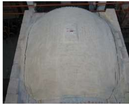
Σχήμα 2.15: Ρωγμές στο σταυροθόλιο εσωτερικά και εξωτερικά
