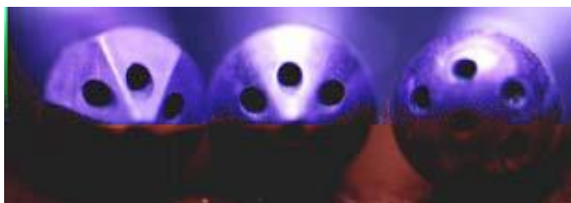
Εικόνα 5: Είδη κορυφών σε σωλήνες Pitot 7 οπών
