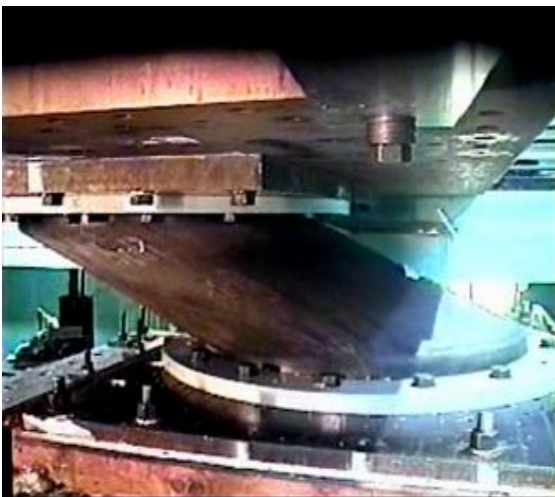
Σχήμα 4.8 Συμπεριφορά ελαστομεταλλικού εφεδράνου σε πείραμα όταν ασκούνται το φορτία σχεδιασμού.
