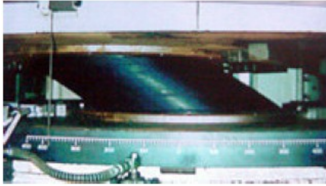
Σχήμα 4.10 Συμπεριφορά ελαστομεταλλικού εφέδρανου στο σεισμό.
