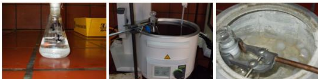
Εικόνα 3.5: Αριστερά: πρόβλημα διαλυτότητας του PBS. Κέντρο: θέρμανση του PBS σε θερμοκρασία υψηλότερη του σημείου τήξης (melting). Δεξιά: η απότομη ψύξη του τήγματος του PBS (quenching)
