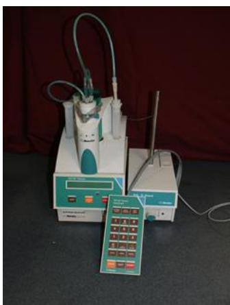
Εικόνα 3.2: Ο αυτόματος τιτλοδότης 716 DMS Titrimatic της εταιρείας Brinkman Instruments, που χρησιμοποιήθηκε για τον προσδιορισμό της συγκέντρωσης των ομάδων -COOH
