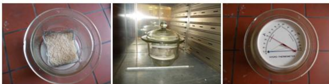
Εικόνα 3.1: Αριστερά: κόκκοι PBS τοποθετημένοι στη σήτα Κέντρο: πειραματική διάταξη Δεξιά: αναλογικό υγρόμετρο
