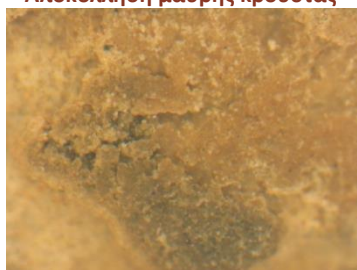
Εικόνα 13: Μεγέθυνση Χ120. Πορτοκαλοκάστανη επιφάνεια με μαύρη κηλίδα
