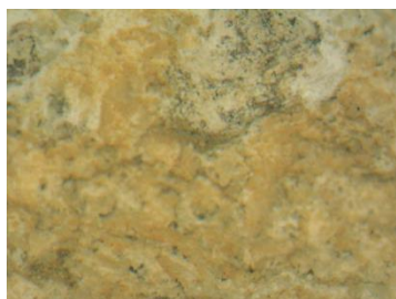
Εικόνα 9: Μαύρες επικαθίσεις. Μεγέθυνση X30
