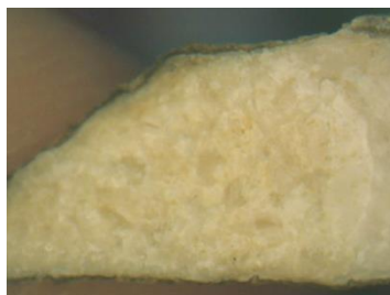
Εικόνα 22: Μεγέθυνση Χ30. Διεπιφάνεια λίθου και κρούστας
