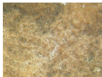
Εικόνα 3: Μεγέθυνση X50. Μαύρη κρούστα με λευκούς σχηματισμούς
