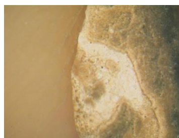
Εικόνα 12: Μεγέθυνση Χ50. Αποκόλληση μαύρης κρούστας
