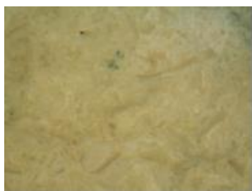
Εικόνα 28: Μεγέθυνση X30. Υγιές τμήμα του λίθου
