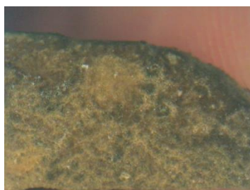
Εικόνα 2: Μεγέθυνση X30. Μαύρη κρούστα με πορτοκαλοκάστανες περιοχές
