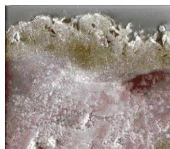
Εικόνα 15: Κατανομή ασβεστίου (κόκκινο χρώμα) – θείου (κίτρινο χρώμα)
