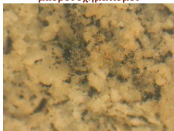
Εικόνα 13: Μεγέθυνση Χ120. Μαύροι σχηματισμοί από τη βιοδιάβρωση
