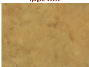
Εικόνα 37: Μεγέθυνση X120. Υγιές τμήμα λίθου
