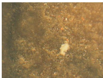
Εικόνα 7: Μεγέθυνση Χ120. Μαύρη κρούστα με λευκό κόκκο
