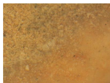
Εικόνα 6: Μεγέθυνση X120. Διεπιφάνεια καστανής και πορτοκαλί περιοχής
