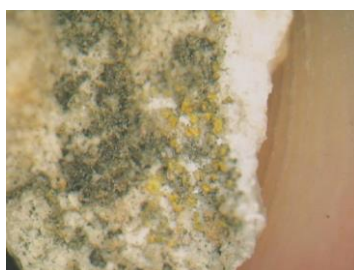
Εικόνα 8: Μεγέθυνση Χ50. Φαιόμαυρη περιοχή και ανάπτυξη κίτρινων σχηματισμών
