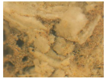
Εικόνα 15: Μεγέθυνση X120. Οπές στην επιφάνεια του λίθου
