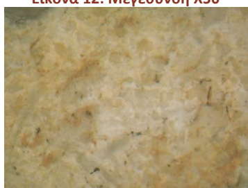
Εικόνα 15: Μεγέθυνση X50. Ραβδοειδείς κρύσταλλοι
