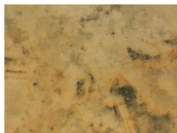
Εικόνα 10: Μεγέθυνση X120. Ραβδοειδείς κρύσταλλοι λίθου
