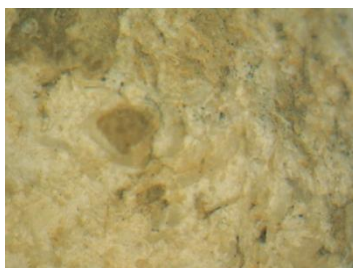
Εικόνα 5: Μεγέθυνση X30. Απώλεια υλικού στις καστανές περιοχές
