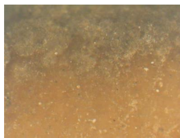
Εικόνα 14: Μεγέθυνση X120. Μαύρη και πορτοκαλοκάστανη περιοχή κρούστας
