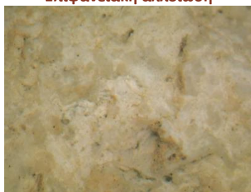
Εικόνα 18: Μεγέθυνση X50. Ραβδοειδείς κρύσταλλοι
