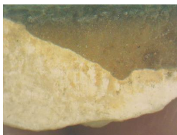
Εικόνα 1: Μεγέθυνση X30. Περιοχή μαύρης κρούστας και αποπλυμένης επιφάνειας
