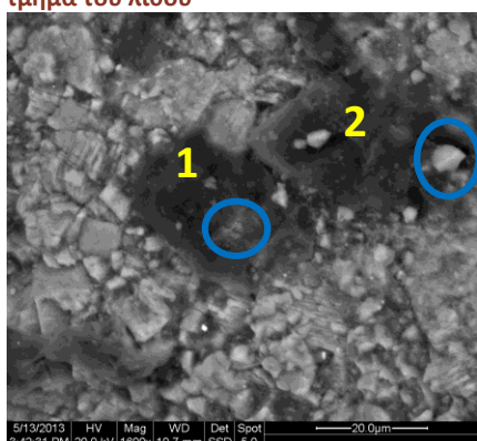
Εικόνα 12: Εικόνα BSE από το λευκό τμήμα του λίθου
