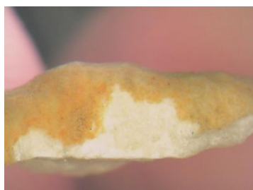
Εικόνα 1: Μεγέθυνση X30. Αποκόλληση πορτοκαλί επιφάνειας
