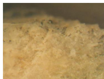
Εικόνα 21: Μεγέθυνση X120. Διεπιφάνεια διαβρωμένης και υγιούς περιοχής
