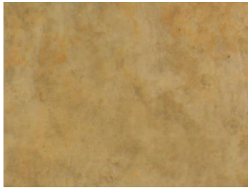
Εικόνα 19: Μεγέθυνση X120. Τμήμα του λίθου που έχει αποπλυθεί
