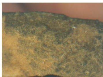
Εικόνα 1: Μεγέθυνση X30. Μαύρη κρούστα με πορτοκαλοκάστανες περιοχές
