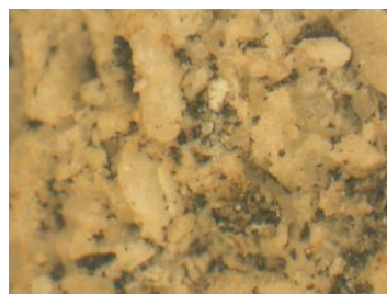
Εικόνα 12: Μεγέθυνση Χ120. Μαύροι σχηματισμοί ανάμεσα στους κόκκους του λίθου
