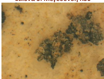
Εικόνα 6: Μεγέθυνση X120. Βελονοειδής διάβρωση
