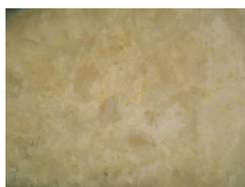
Εικόνα 36: Μεγέθυνση X50. Υγιές τμήμα λίθου
