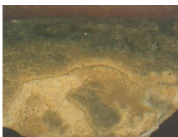
Εικόνα 11: Μεγέθυνση Χ50. Αποκόλληση μαύρης κρούστας
