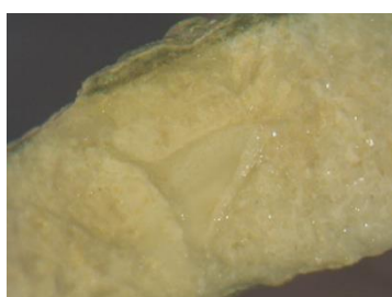
Εικόνα 34: Μεγέθυνση X30. Υγιές τμήμα λίθου
