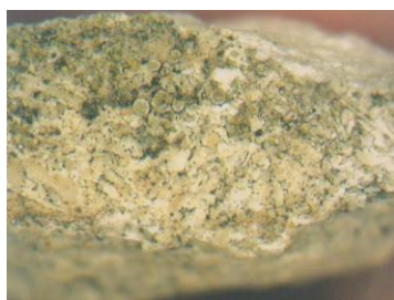
Εικόνα 4: Μεγέθυνση Χ30. Καρπικές δομές και μαύρες κρούστες
