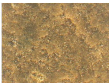
Εικόνα 5: Μεγέθυνση Χ120. Μαύρη κρούστα με πορτοκαλοκάστανες περιοχές
