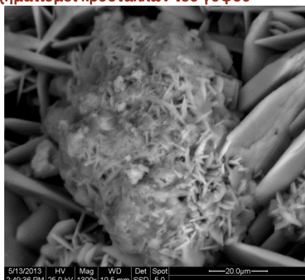
Εικόνα 4: Εικόνα BSE. Μεγέθυνση X1300 στον σπογγοειδή σχηματισμό
