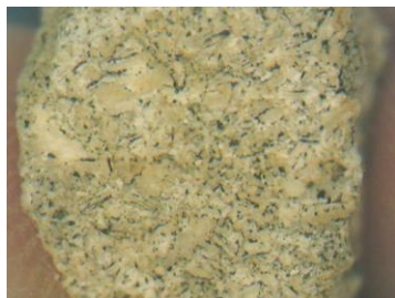
Εικόνα 1: Μεγέθυνση X30. Κατακερματισμένος λίθος από την απόπλυση και τη βιολογική διάβρωση
