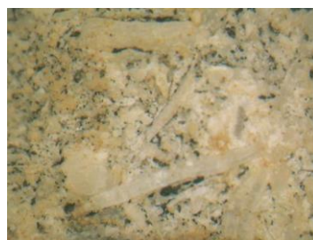
Εικόνα 6: Μεγέθυνση Χ50. Ραβδοειδείς κρύσταλλοι λίθου
