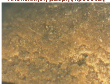
Εικόνα 14: Μεγέθυνση Χ120. Περιοχή μαύρης κρούστας με απώλεια υλικού
