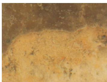
Εικόνα 16: Μεγέθυνση X120. Διεπιφάνεια κρούστας και αποπλυμένης περιοχής
