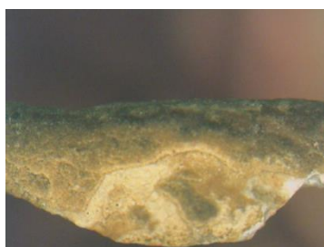
Εικόνα 10: Μεγέθυνση Χ30. Αποκόλληση μαύρης κρούστας
