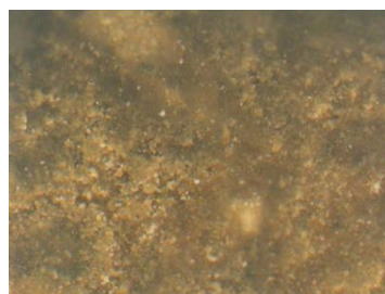
Εικόνα 6: Μεγέθυνση Χ120. Μαύρη κρούστα με λευκό κόκκο ασβεσίτη
