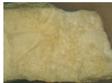
Εικόνα 23: Μεγέθυνση Χ30. Διεπιφάνεια λίθου και κρούστας
