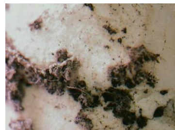
Εικόνα 12: Βιολογική διάβρωση σε αποπλυμένη επιφάνεια
