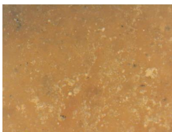
Εικόνα 13: Μεγέθυνση X120. Πορτοκαλοκάστανη περιοχή κρούστας
