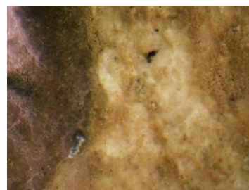
Εικόνα 3: Αποκόλληση μαύρης κρούστας
