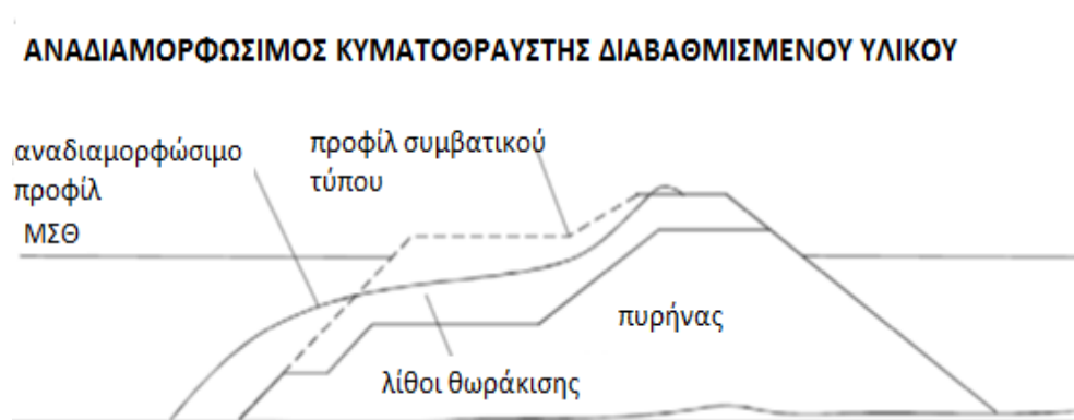
Σχήμα 6.7: Κυματοθραύστης με αναμορφώσιμο πρανές
