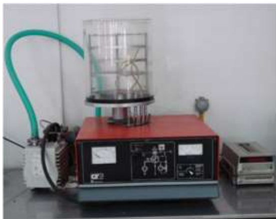
Εικόνα 20 Συσκευή ξήρανσης υπό κατάψυξη (Leybold-Heraeus GT 2A).
