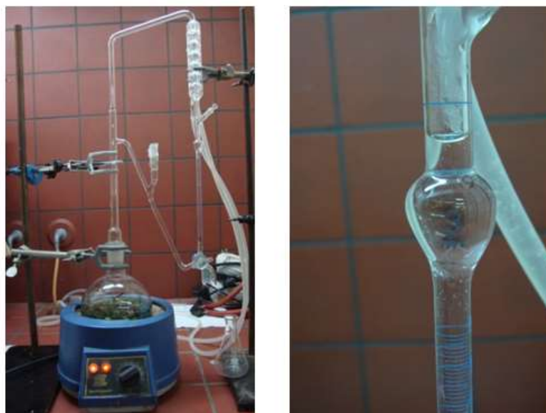
Εικόνα 27 αριστερά: Συσκευή Clevenger, δεξιά: Μέτρηση αιθερίου ελαίου στη συσκευή
