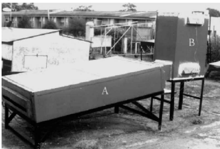
Εικόνα 69: Φωτογραφία ενός συστήματος θέρμανσης αέρα. (Α) Κατασκευή συλλέκτη και υποσυστημάτων αποθήκευσης ενέργειας και θέρμανσης αέρα. (Β) Θερμαινόμενος χώρος [92].
