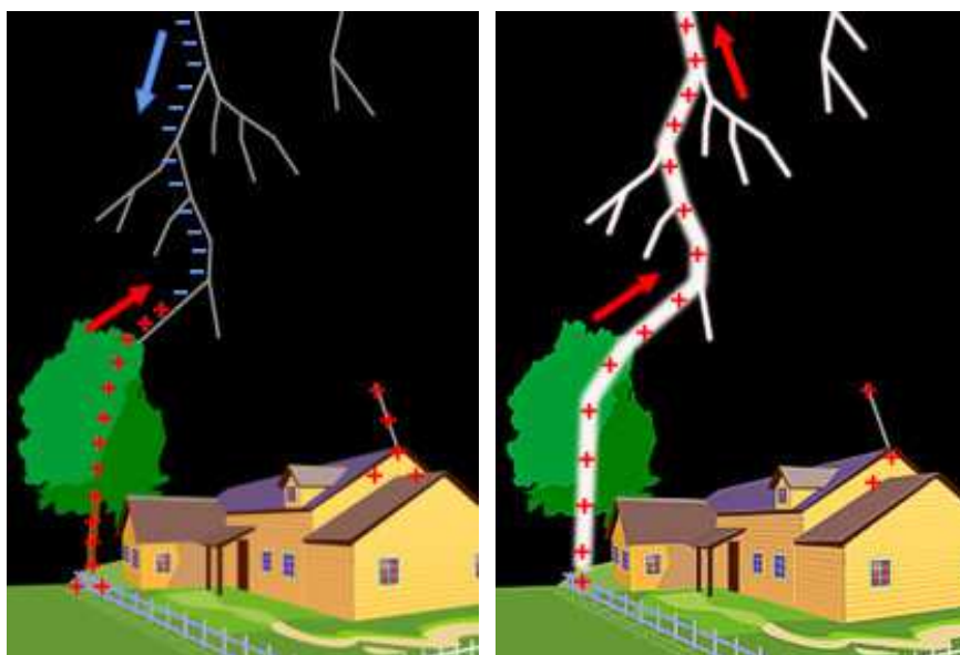
Σχήμα 6.3. Βήματα 3 και 4 για τη δημιουργία κεραυνού ( http://www.srh.noaa.gov ).
