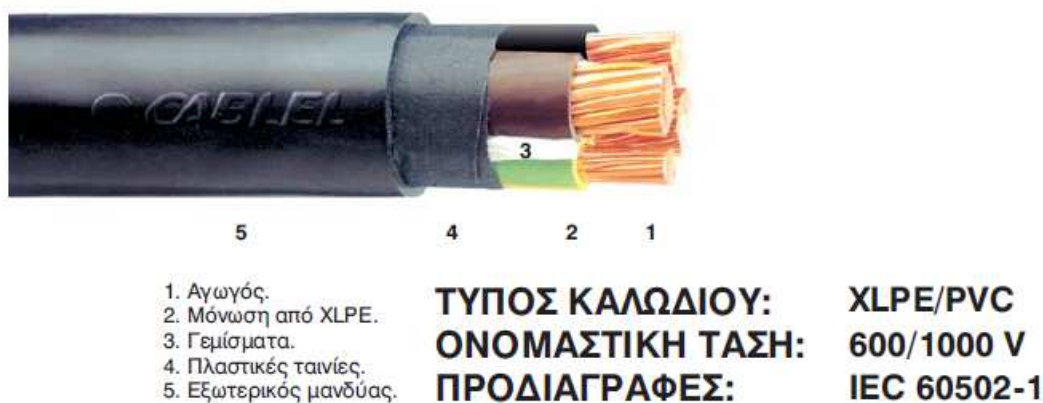
Σχήμα 5.9. Καλώδιο XLPE/PVC..
