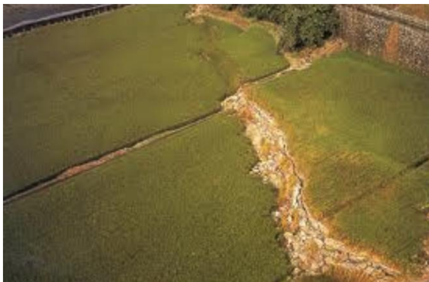
Εικόνα 5.54. Φωτογραφία από το σεισμό της Ταιwan, όπου διακρίνεται το πλάτος της ζώνης των επιφανειακών ρωγματώσεων
