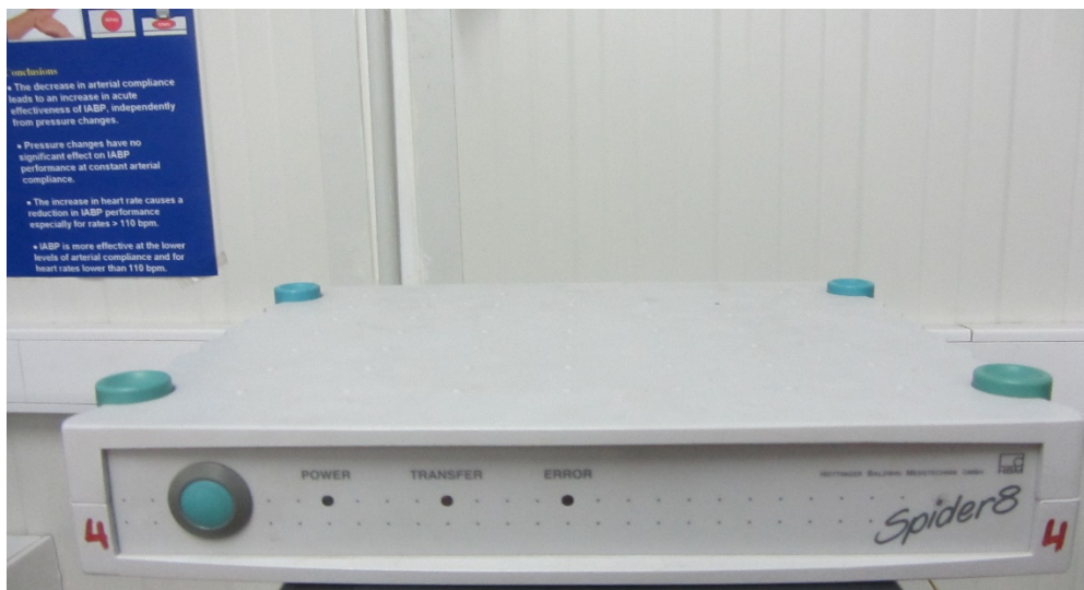
Εικόνα 3.7: Μετατροπέας Spider αναλογικού σήματος αισθητήρα πίεσης σε ψηφιακό
