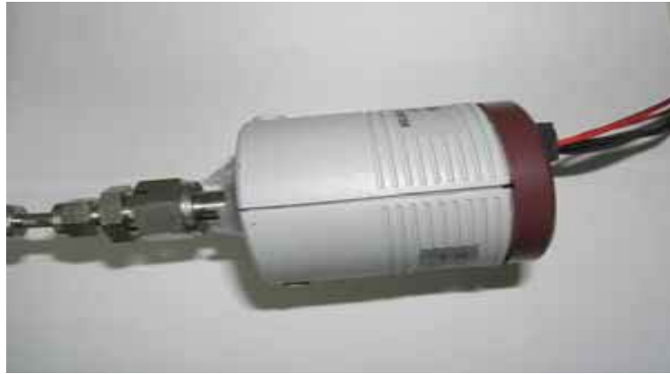
Εικόνα 3.5: Αισθητήρας Πίεσης MKSBaratron 622A
