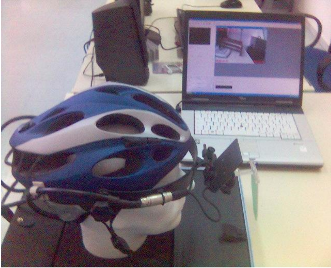
Φωτογραφία 5 Εξοπλισμός καταγραφής οφθαλμικών κινήσεων SMI σε Εργαστήριο του Τομέα Βιομηχανικής Διοίκησης & Επιχειρησιακής Έρευνας του Ε.Μ.Π.
