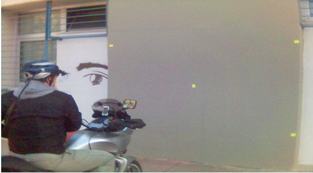
Φωτογραφία 8 Τοποθέτηση σημαδιών σε επιφάνεια, για τη βαθμονόμηση των συσκευών καταγραφής οφθαλμικών κινήσεων.
