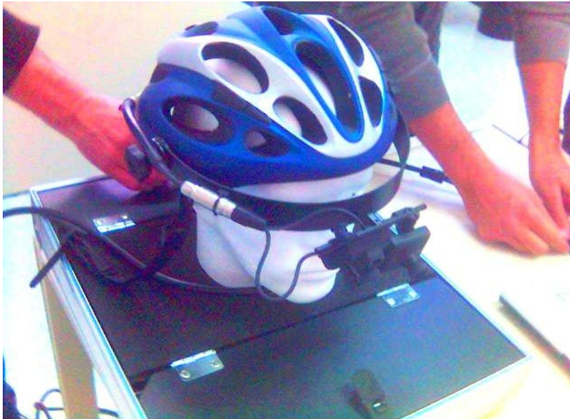
Φωτογραφία 3 Εξοπλισμός καταγραφής οφθαλμικών κινήσεων SMI. Κράνος και οι αναρτημένες κάμερες σε αυτό.
