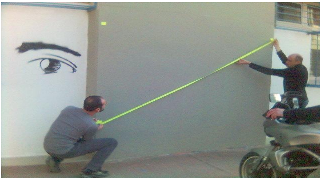
Φωτογραφία 7 Τοποθέτηση σημαδιών σε επιφάνεια, για τη βαθμονόμηση των συσκευών καταγραφής οφθαλμικών κινήσεων. Διακρίνεται ο Λέκτορας Ε.Μ.Π. κος Ναθαναήλ Δημήτριος (δεξιά) και ο Ι.Δ.Α.Χ. Ε.Μ.Π. κος Γκίκας Κωνσταντίνος (αριστερά).
