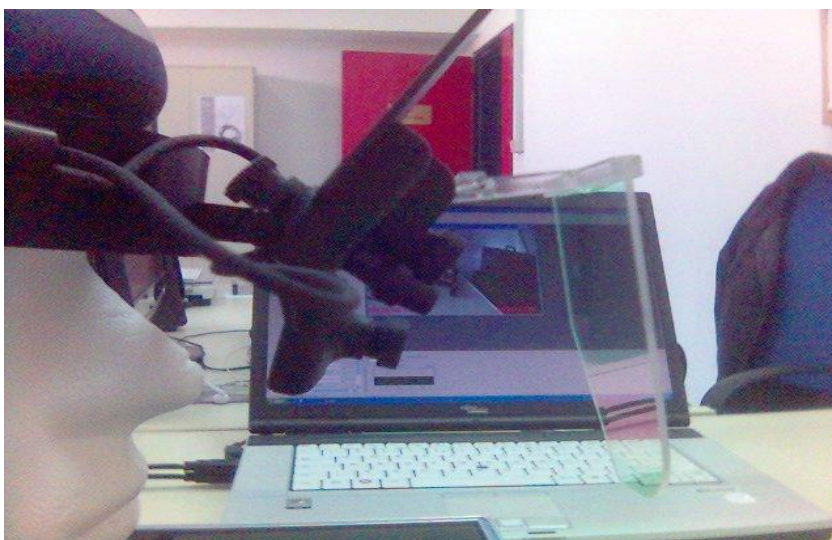
Φωτογραφία 4 Εξοπλισμός καταγραφής οφθαλμικών κινήσεων SMI. Κράνος, κάμερες και Η/Υ εφοδιασμένος με κατάλληλο λογισμικό.
