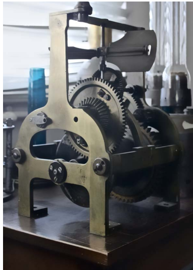
εικ. 27 | Ωρολογιακός μηχανισμός περιστροφής φάρων
