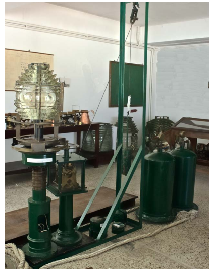
εικ. 28 | Πλήρες σύστημα περιστροφικού οπτικού με αντίβαρο
