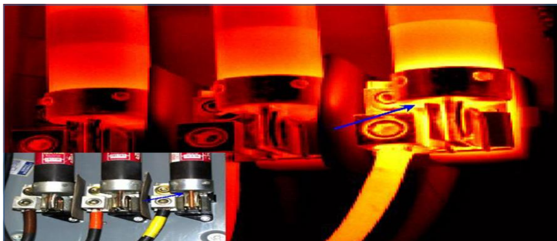
Εικόνα 3.8 : Η μέθοδος της θερμογραφίας.
