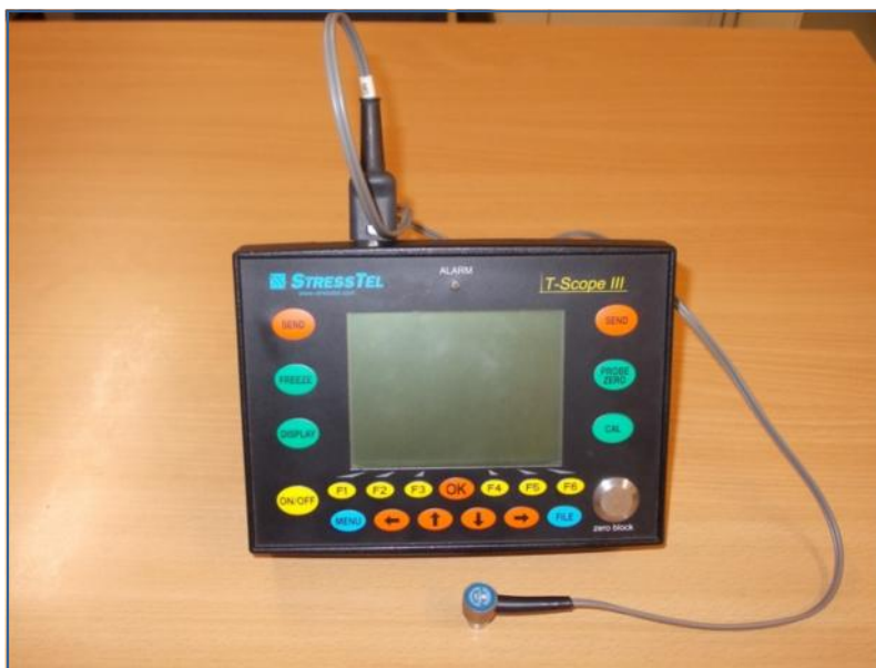
Εικόνα 6.9 : Φορητή συσκευή παχυμέτρησης StressTel T-SCOPE III.
