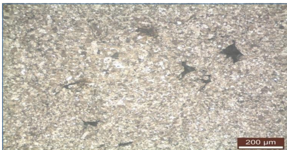
Εικόνα 7.9 : Μικροσκοπικός έλεγχος ατέλειας δοκιμίου 12.
