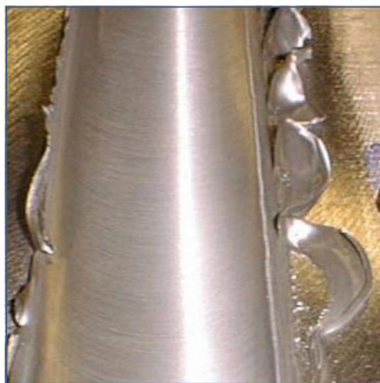
Εικόνα 7.12 : Υπόδειγμα – Περιγραφή ατέλειας τύπου ribbonflash.
