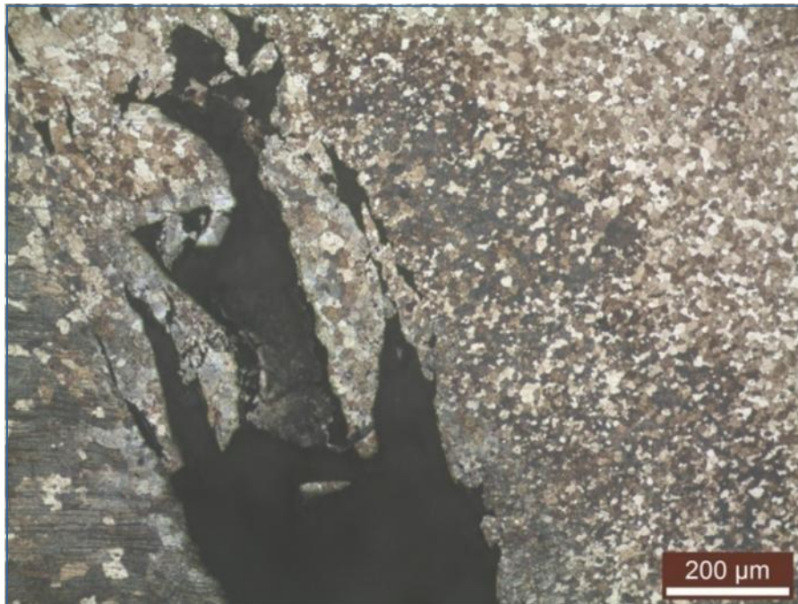
Εικόνα 7.5 : Μικροσκοπικός έλεγχος και επαλήθευση ατέλειας τύπου τούνελ.
