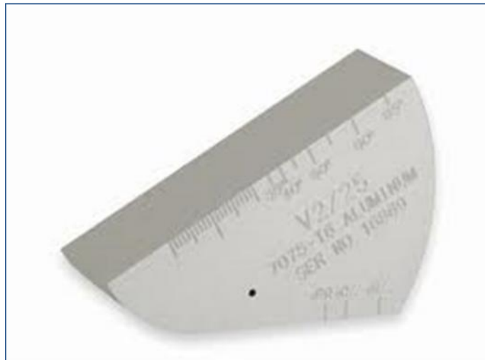
Εικόνα 6.8 : Πρότυπο βαθμονόμησης κεφαλής γωνιακής δέσμης.
