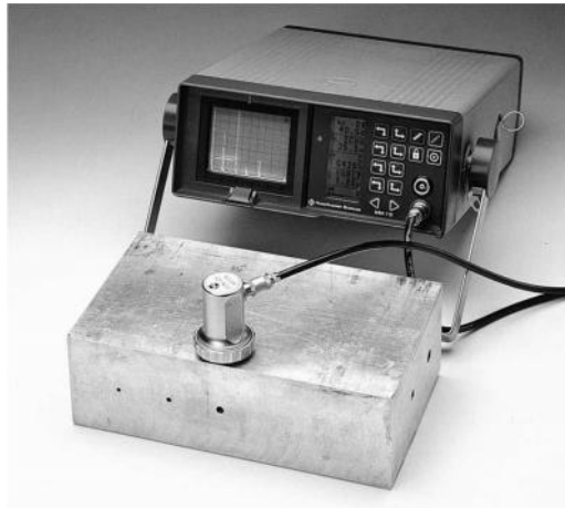
Fig. 44 USK 7 D: Sound path measurement.
