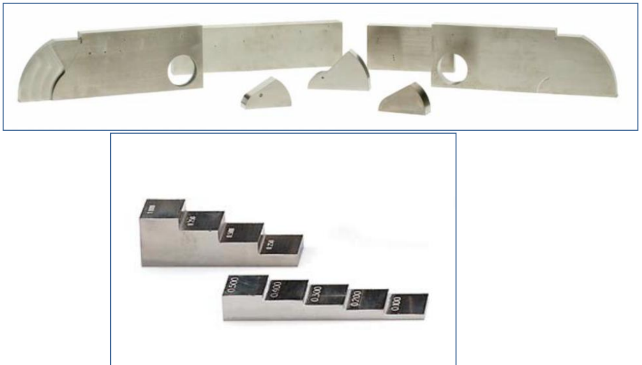
Εικόνα 5.8 : Διάφοροι τύποι πρότυπων βαθμονόμησης.
