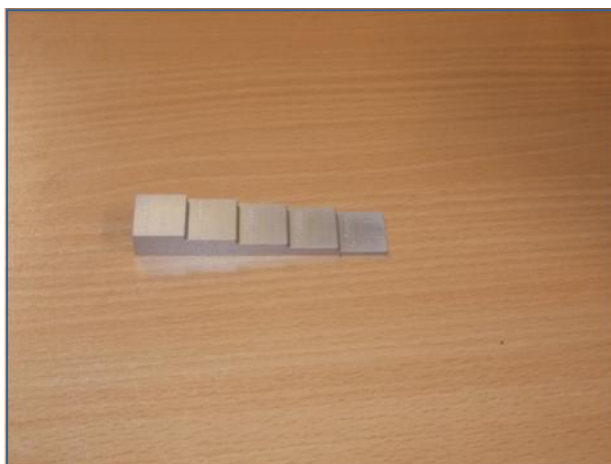
Εικόνα 6.7 : Πρότυπο βαθμονόμησης κεφαλής καθέτου δέσμης.
