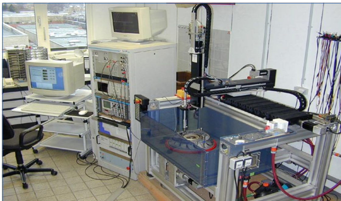
Εικόνα 5.2 : Εμβαπτιζόμενη διάταξη ελέγχου.
