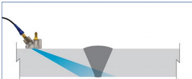
Εικόνα 6.5 : Εκπομπή γωνιακής κεφαλής στη ρίζα συγκόλλησης.
